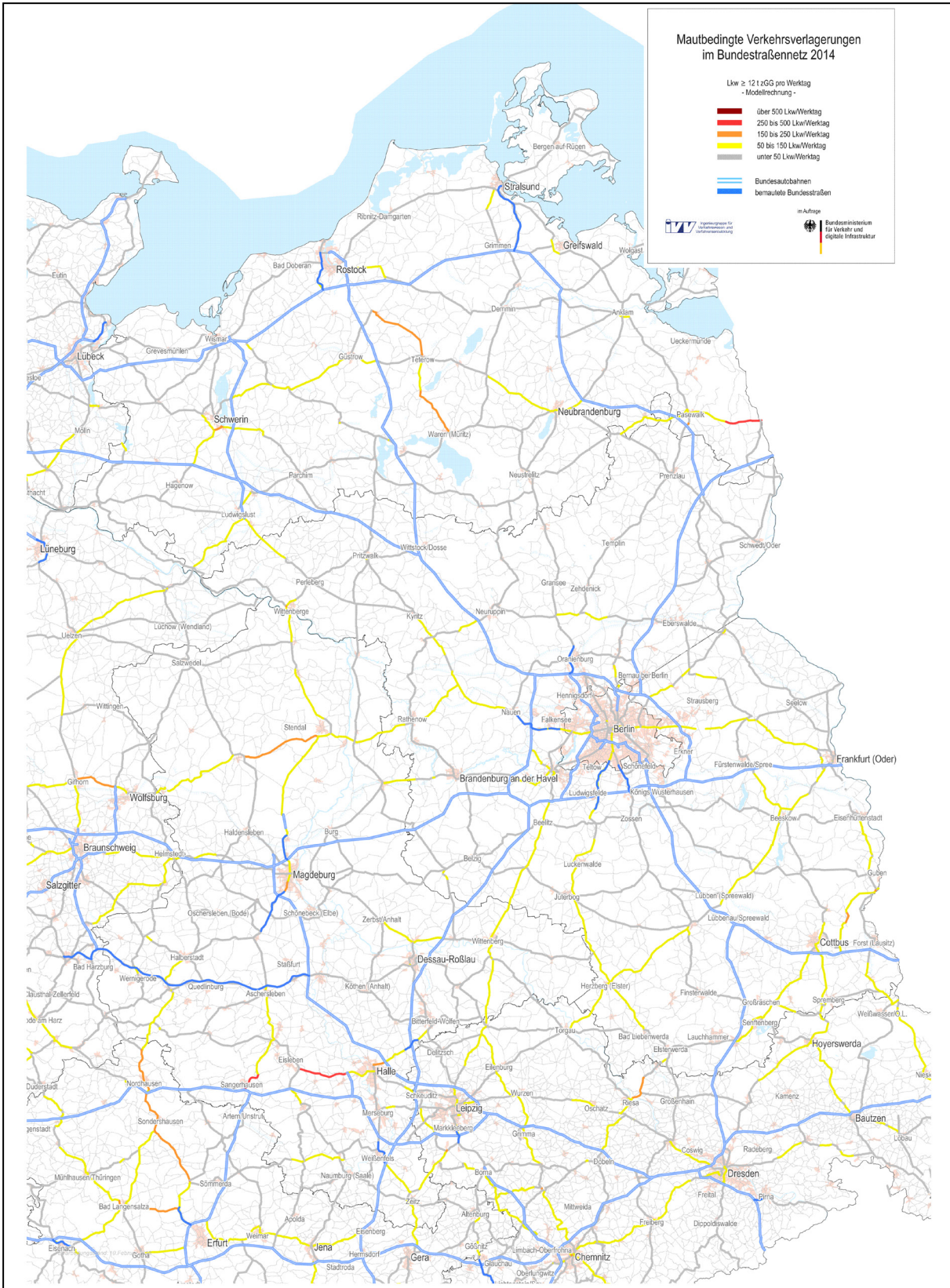
Bild A 4: Mautverlagerungen 2014 (Ergebnis der Modellrechnungen) Ausschnitt: Berlin, Brandenburg, Mecklenburg-Vorpommern, Sachsen-Anhalt Quelle: Ingenieurgruppe IVV-Aachen
