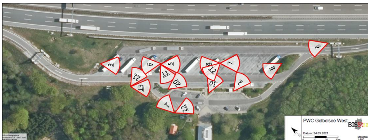
Abbildung 4: Position und schematischer Sichtkegel der Kameras für die manuelle Bestimmung der Belegungssituation (Quelle Hintergrundbild: Geobasisdaten: © Geobasis-DE/ BKG 2020)
