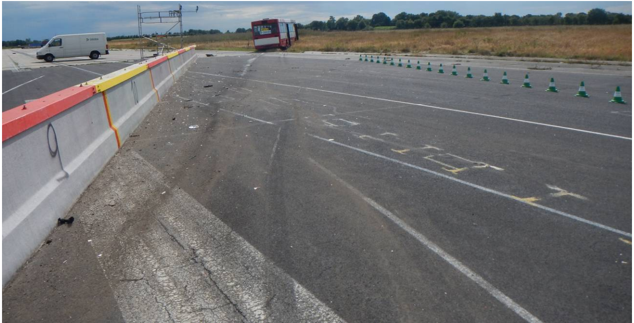
Bild 8 Endlage des Fahrzeugs nach dem Anprallversuch
