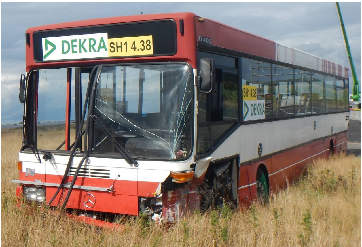
Bild 9 Versuchsfahrzeug nach dem Anprallversuch
