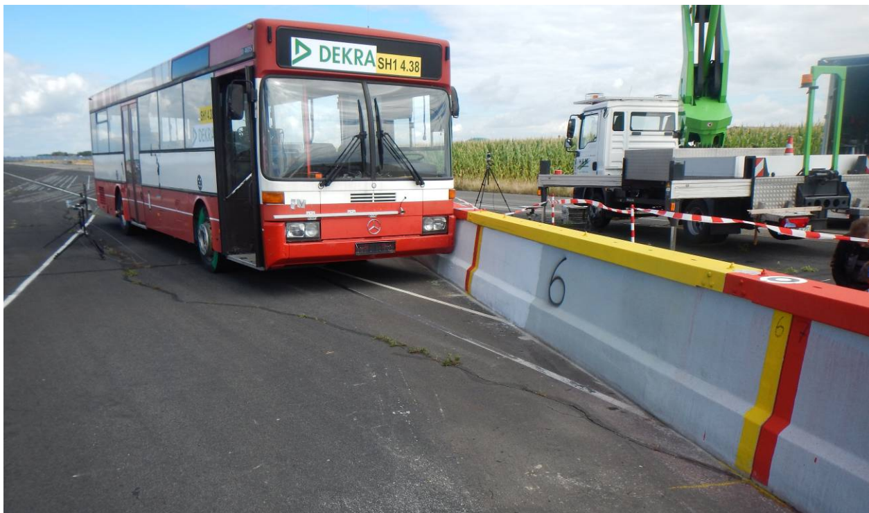
Bild 6 Stellprobe des Fahrzeugs am erwarteten Anprallpunkt
