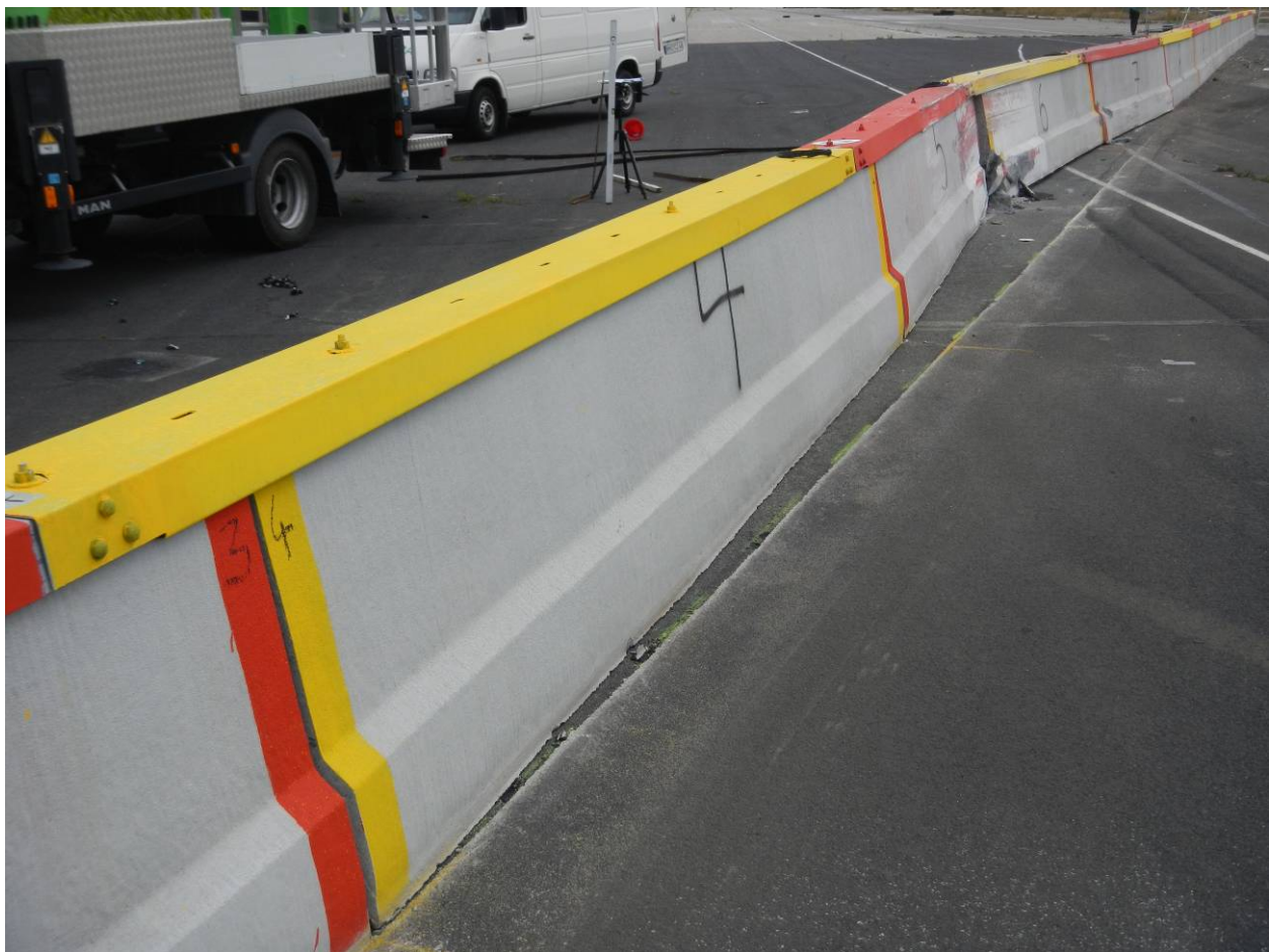
Bild 10 Anprallbereich nach dem Anprallversuch (Ansicht von vorne in Anprallrichtung)
