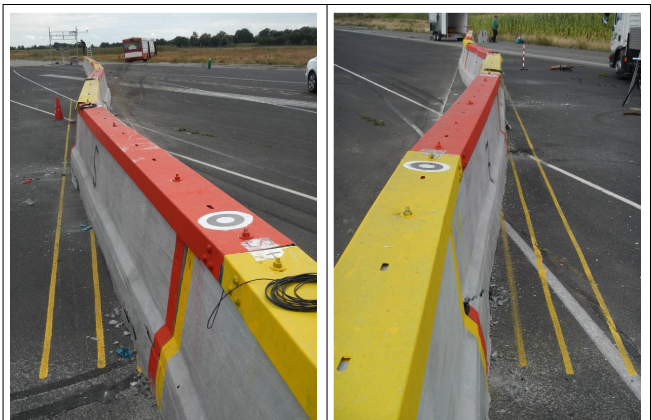
Bild 17 Querverschiebung in (links) und gegen Anprallrichtung (rechts) gesehen
