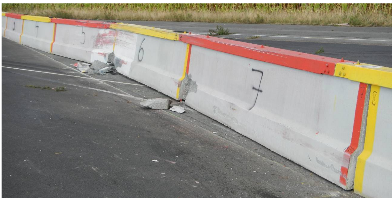
Bild 11 Anprallbereich nach dem Anprallversuch (Ansicht von vorne gegen Anprallrichtung)
