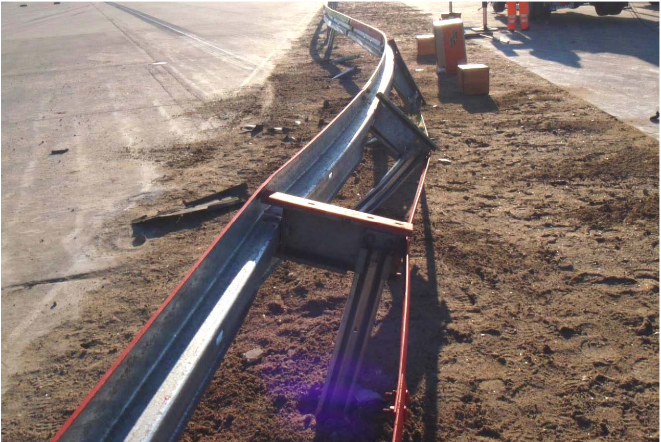
Bild 7: Anprallbereich Systemrückseite (entgegen die Anprallrichtung gesehen)
