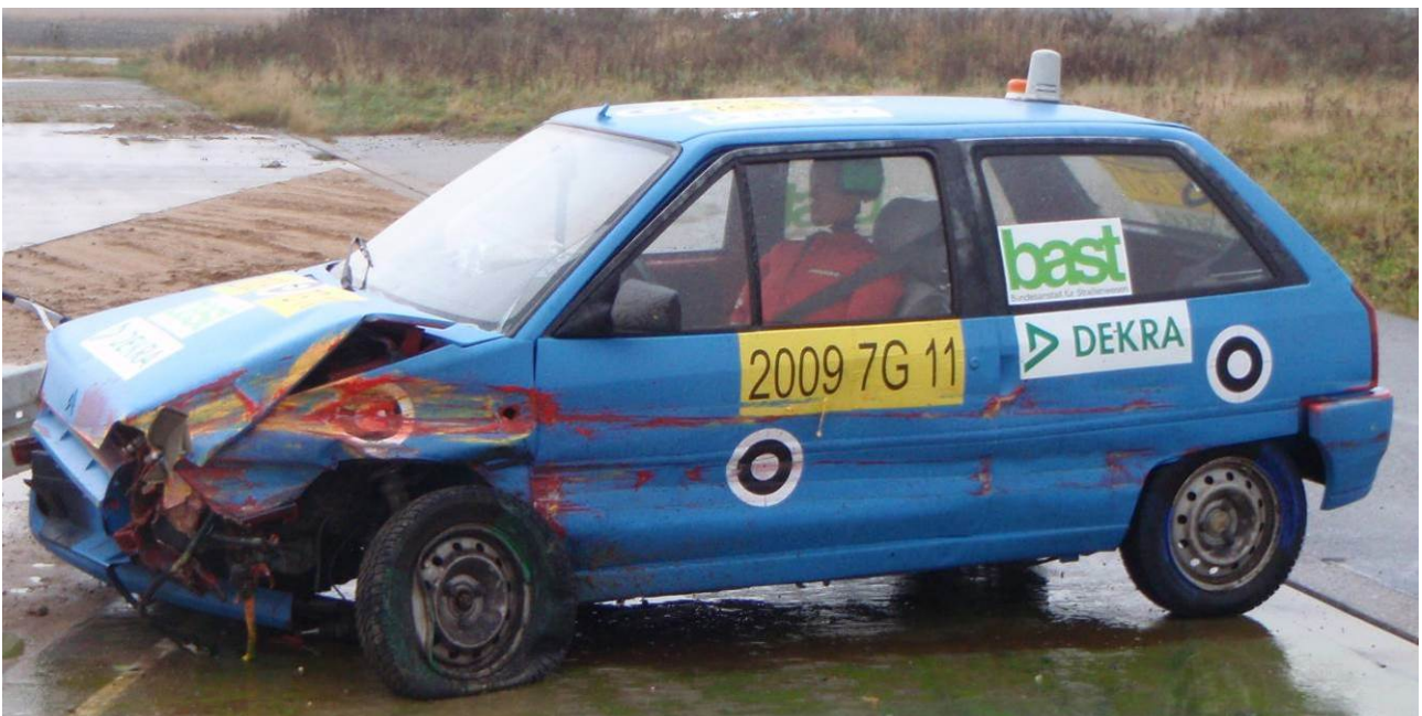
Bild 7: Versuchsfahrzeug nach Crash
