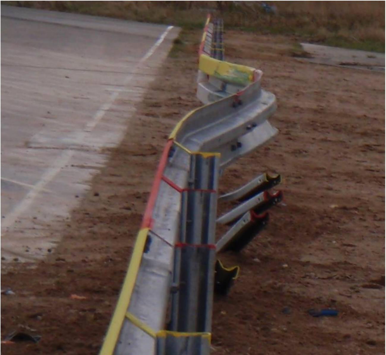
Bild 9: Verschiebung der Schutzeinrichtung im Primäranprallbereich
