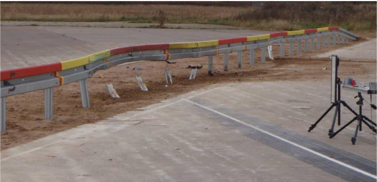
Bild 4: Schutzeinrichtung nach dem Versuch (Ansicht in Anprallrichtung)
