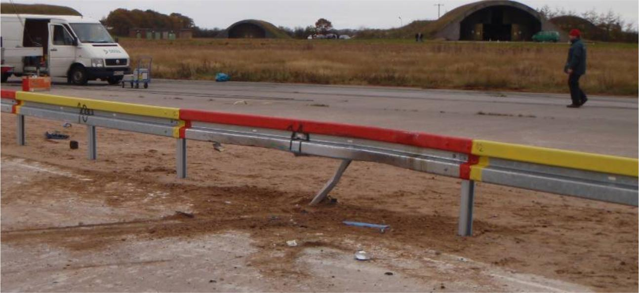
Bild 7: Sekundäranprall (Ansicht entgegen Anprallrichtung)
