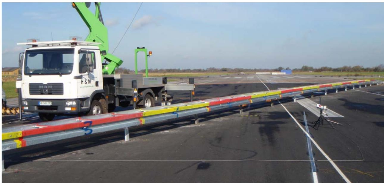
Bild 1: Schutzeinrichtung vor Anprallversuch (Ansicht in Anprallrichtung)
