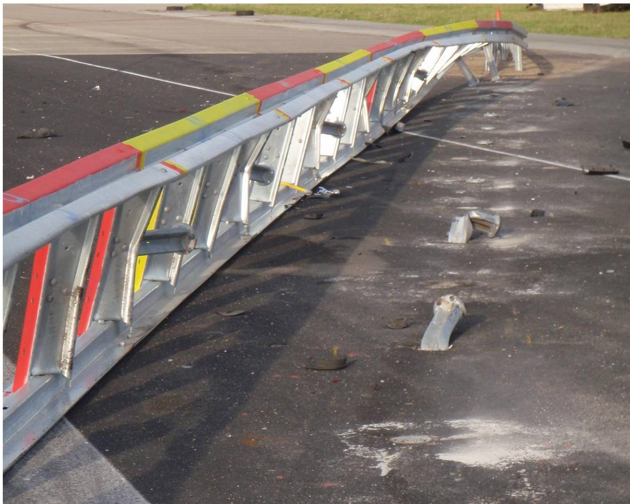
Bild 20: Rückwärtiger Teil der Schutzeinrichtung (Ansicht in Anprallrichtung)
