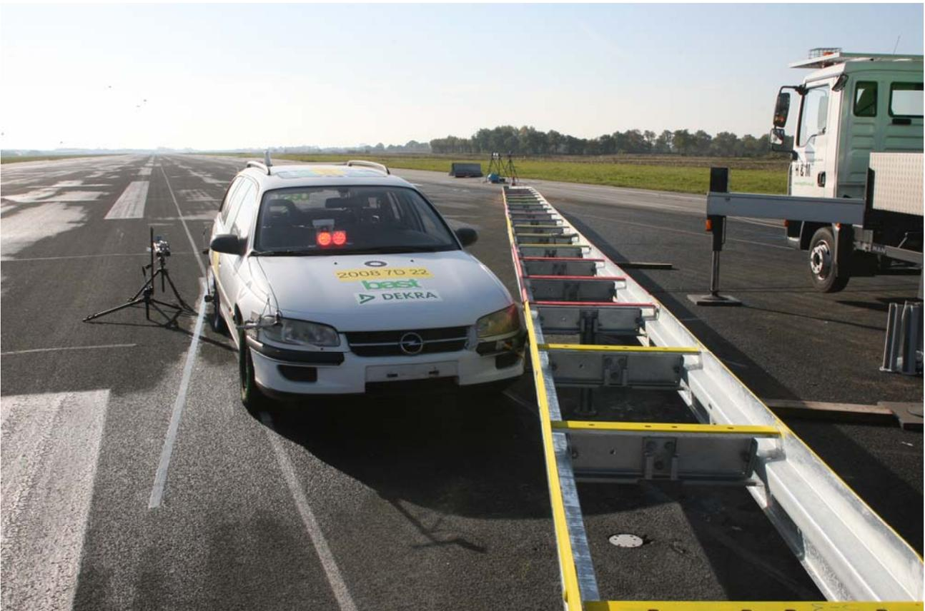
Bild 8: Fahrzeugstellprobe am erwarteten Anprallpunkt
