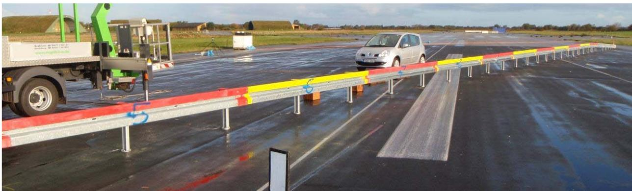
Bild 1: Schutzeinrichtung vor Anprallversuch (Ansicht in Anprallrichtung)
