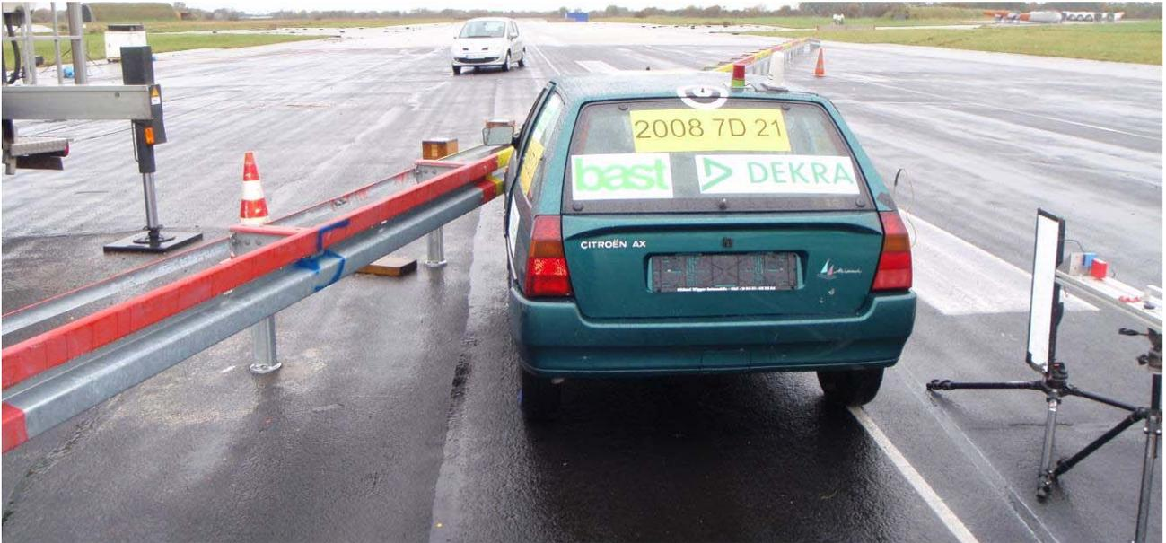
Bild 5: Fahrzeugstellprobe im Anprallpunkt
