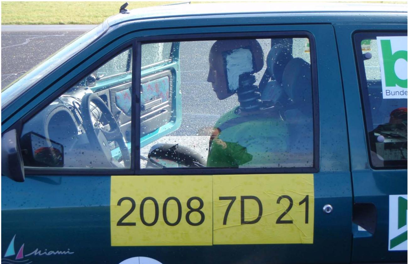
Bild 15: Dummy vor dem Anprallversuch
