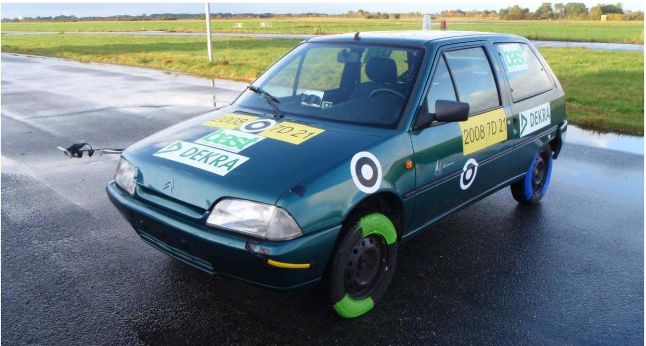
Bild 6: Fahrzeug vor Anprallversuch
