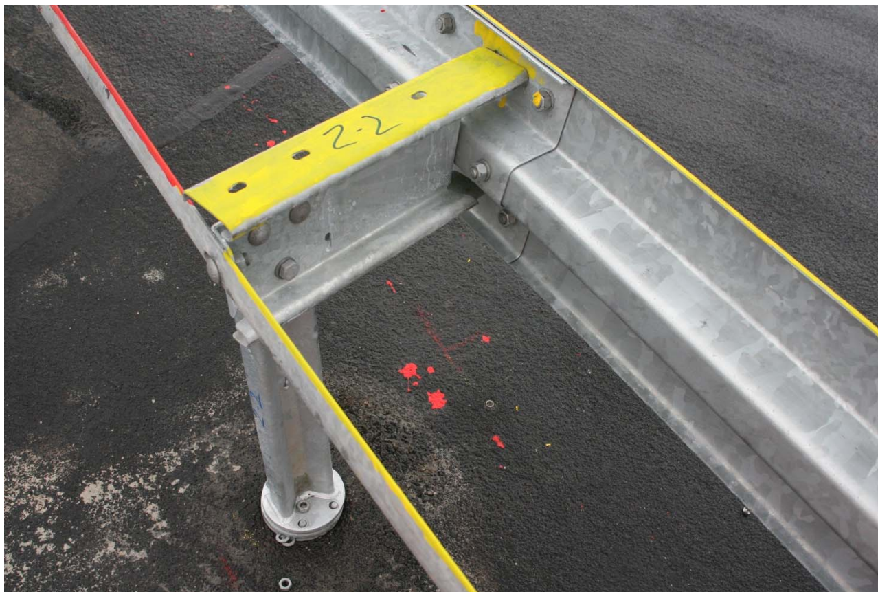
Bild 10: Gelöste Verschraubung bei Steckpfosten 2-2
