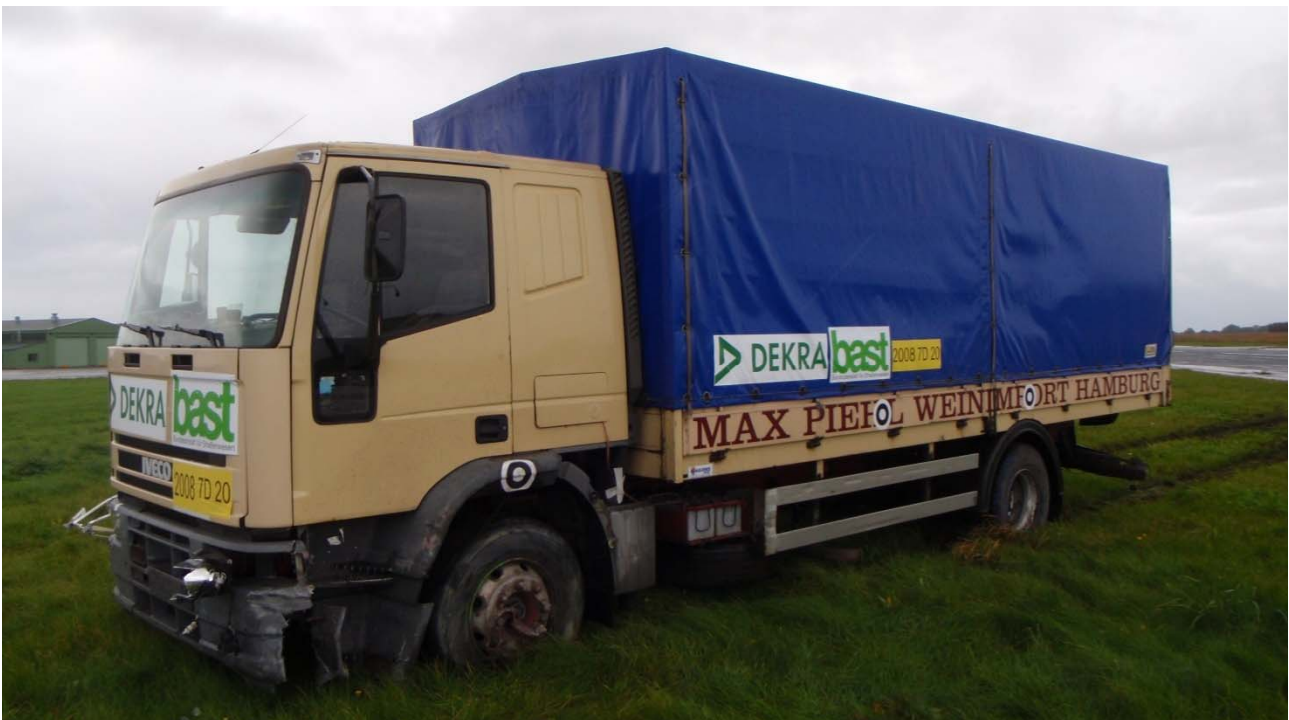
Bild 23: Fahrzeug nach Crash
