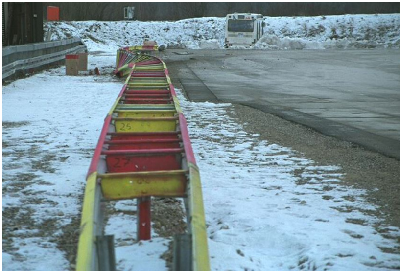
Bild 18: Schutzeinrichtung nach der Prüfung und Fahrzeug in Endposition
