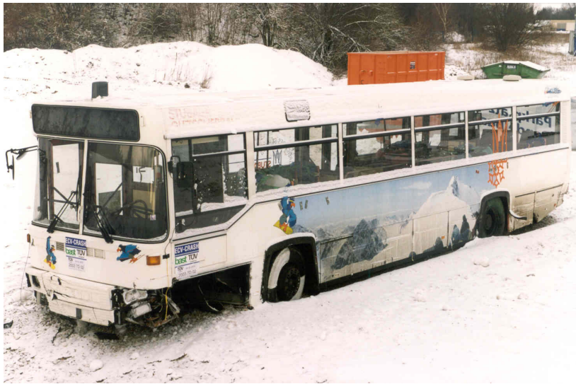
Bild 25: Fahrzeugschäden (linke Fahrzeugseite und Front)
