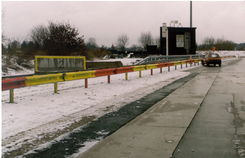
Bild 4: Systemübersicht mit Fahrzeug am erwarteten Anprallpunkt
