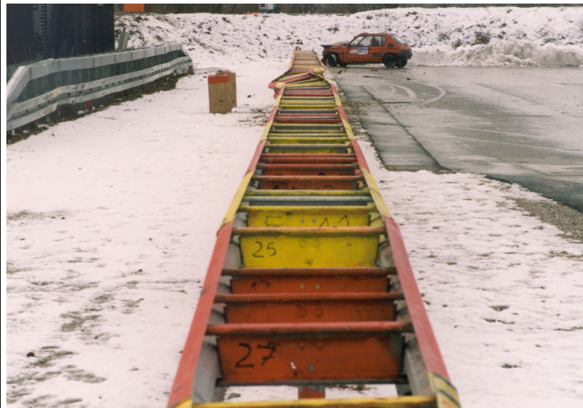
Bild 19: Schutzeinrichtung nach der Prüfung und Fahrzeugendstellung von oben
