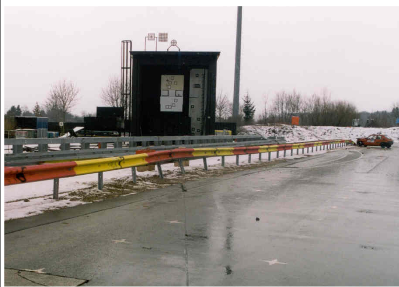
Bild 18: Schutzeinrichtung nach der Prüfung und Fahrzeug in Endstellung
