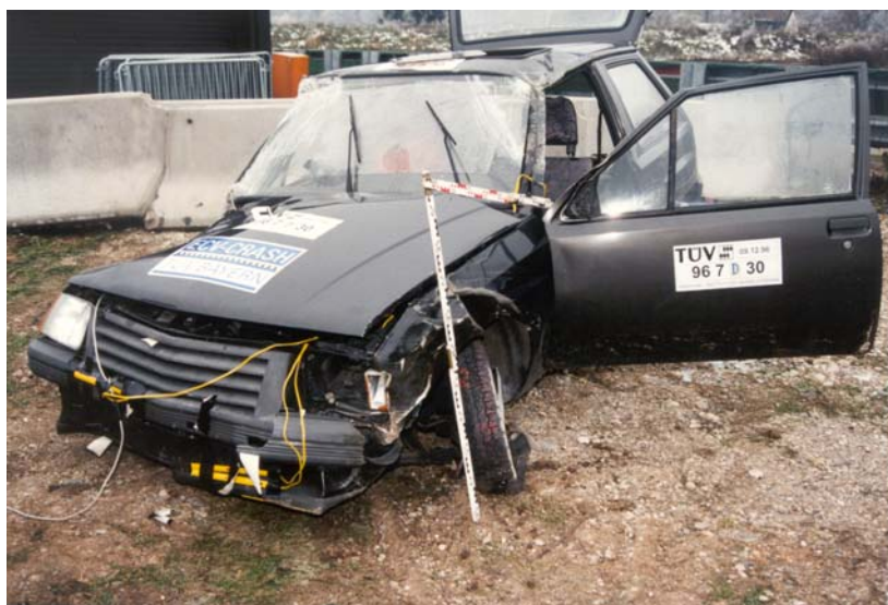
Bild 21: Fahrzeugschäden (vordere linke Fahrzeugecke und Vorderrad)
