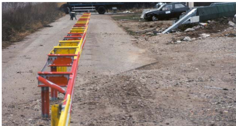
Bild 17: Angeschlossene Schutzeinrichtung nach der Prüfung und Fahrzeugendstellung
