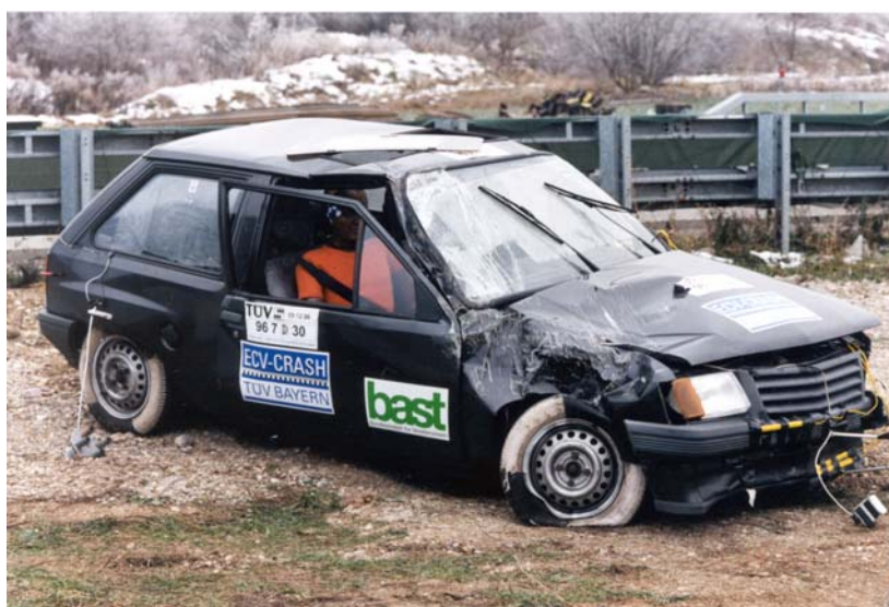
Bild 22: Fahrzeugschäden (Dach und Beifahrerseite durch Sekundäranprall)
