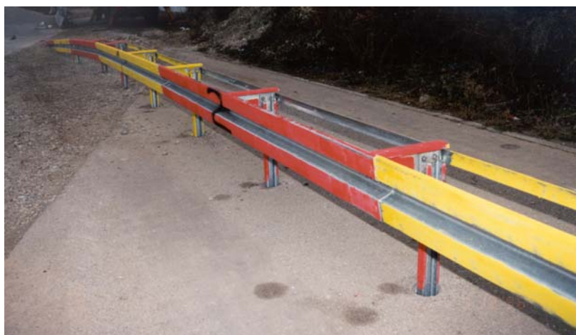
Bild 19: Detail: Kratzspuren an Holm 2
