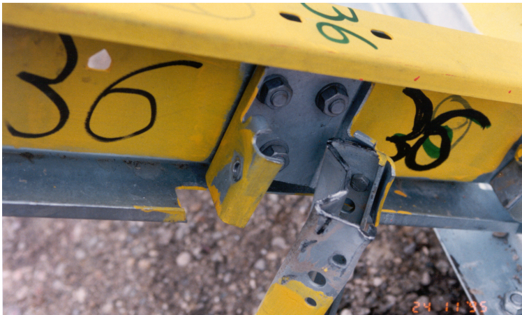
Bild 20: Detail: einseitig gelöste Pfostenklaue
