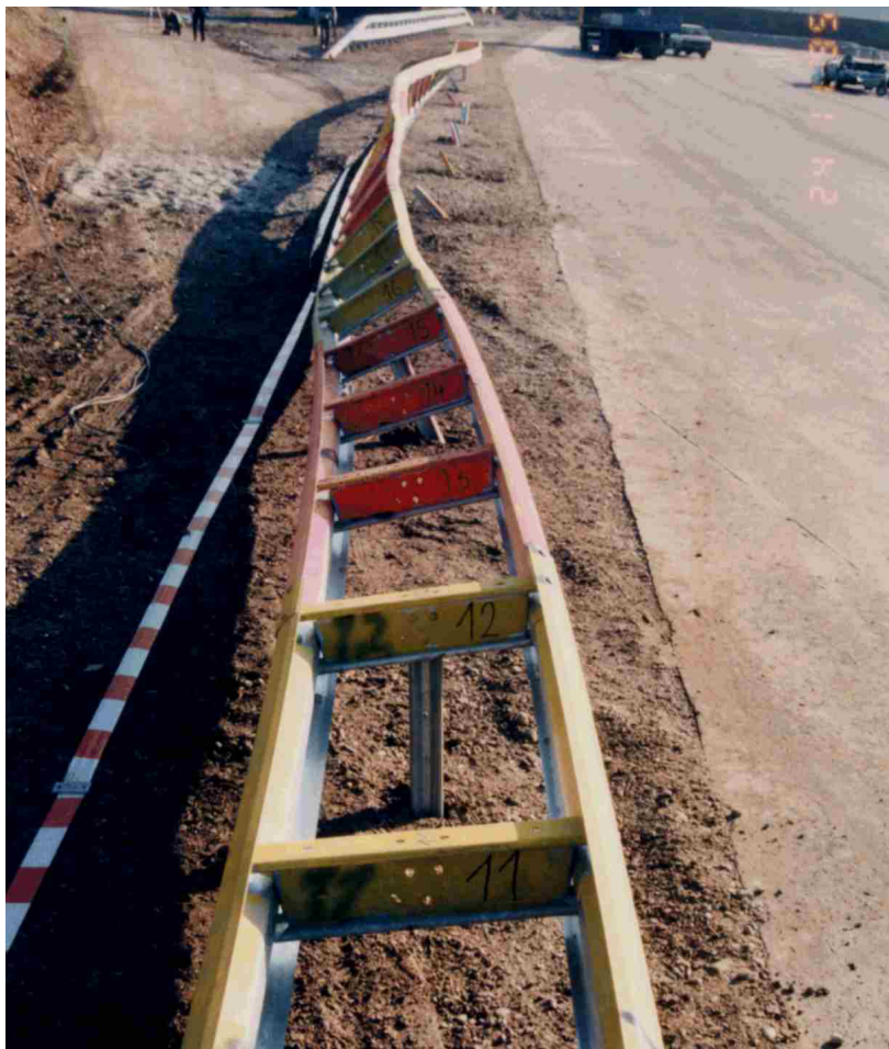
Bild 16: Verschiebung der Schutz- einrichtung
