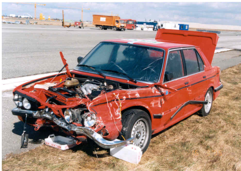
Bild 15: Fahrzeugschäden (linke Fahrzeugseite und Front)
