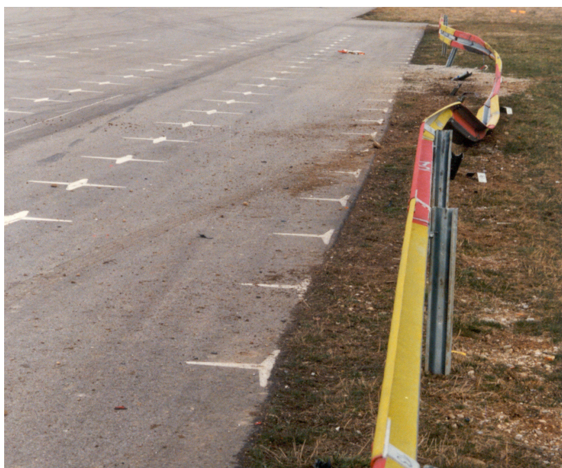
Bild 11: Schutzeinrichtung nach der Prüfung
