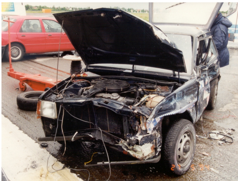
Bild 14: Fahrzeugschäden (Front) [nach Sekundäranprall]
