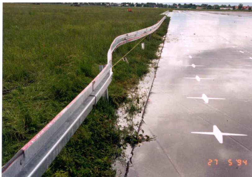
Bild 7: Verschiebung der Schutz- einrichtung
