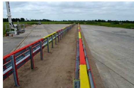
b) Schutzeinrichtungen aus Stahl
