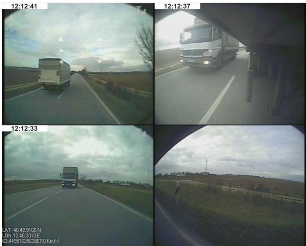
Bild 31: Beispielbilder der am Lang-Lkw angebrachten Kameras. Links oben Frontkamera, links unten Heckkamera, rechts Seitenkameras (Spedition A)
