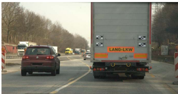
Bild 29: Fahrt eines Lang-Lkw durch eine Überleitung
