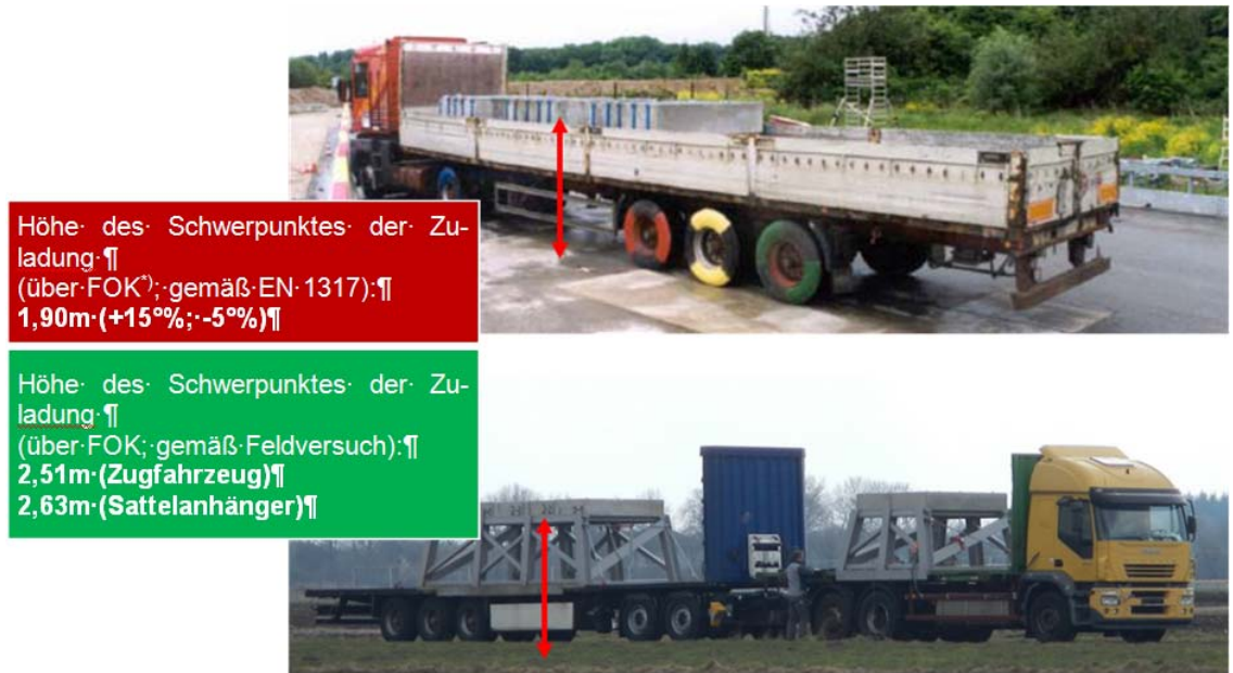
Bild 29: Beladungsszenarien der Prüffahrzeuge gemäß DIN EN 1317 (oben) und für Lang-Lkw aus dem Feldversuch (unten) im Vergleich
