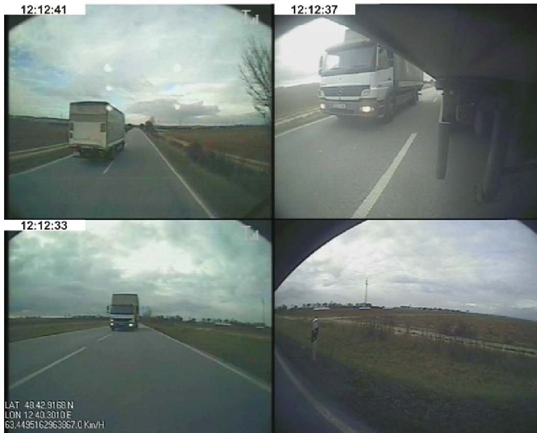
Bild 42: Beispielbilder der am Lang-Lkw angebrachten Kameras. Links oben Frontkamera, links unten Heckkamera, rechts Seitenkameras (Spedition A)
