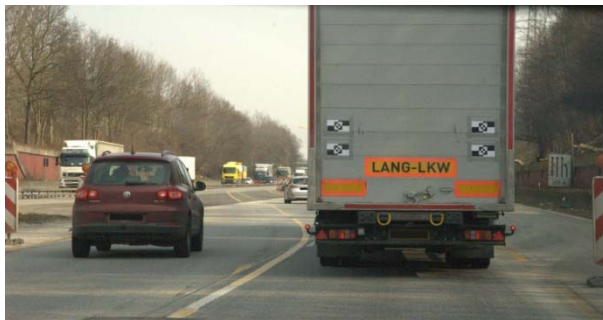
Bild 40: Fahrt eines Lang-Lkw durch eine Überleitung
