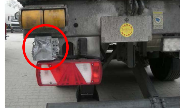
Oben: Anbringung der Aufzeichnungsbox sowie Radarbox mit GPS-Empfänger am Fahrzeuganhänger Unten: Ansicht der Radarbox (über der linken Heckleuchte)
