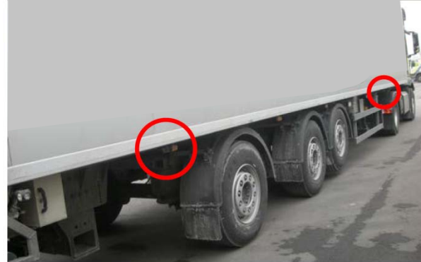
Anbringung der Seitenkameras (roter Kreis) sowie die standardmäßig installierte Seitenkamera (gelber Kreis) am Auflieger
