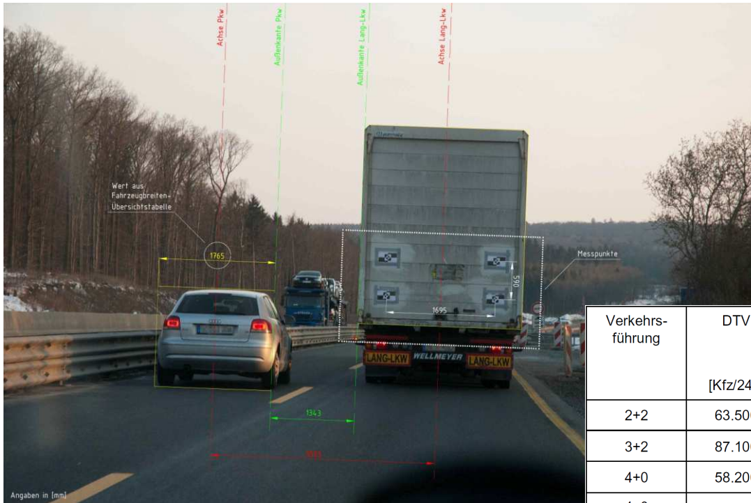
Messung der seitlichen Abstände zwischen Lang-Lkw und überholendem Kfz
