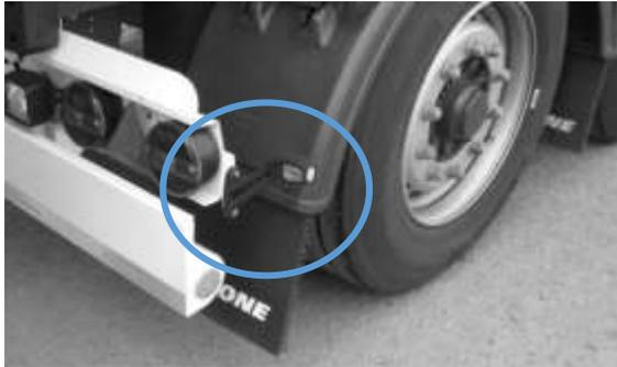
Bild 13 Spuralhalteleuchten nach § 51 Absatz 4 der StVZO
