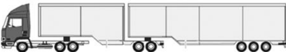
Typ 4: Sattelkraftfahrzeug mit einem weiteren Sattelanhänger bis zu einer Gesamtlänge von 25,25 Metern
