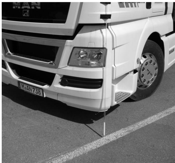
Bild 18 Peilhilfe an vorderer, äußerer Ecke des Fahrzeugs für die Kreisfahrt nach § 32d der StVZO
