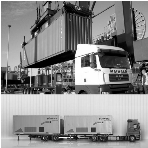
Bild 6 Oben: Verladung eines Containers auf ein Wechselchassis. Unten: Beispielhafte Verladung von Wechselbehälter
