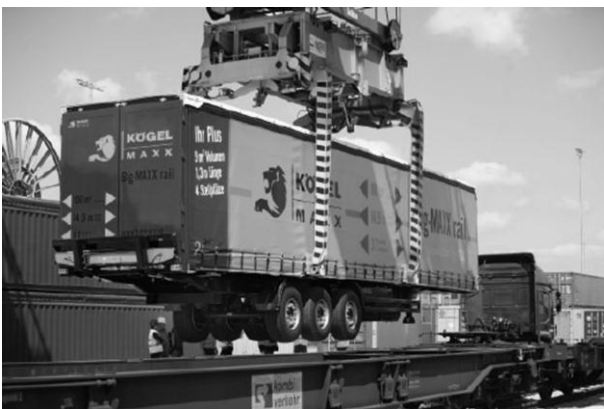
Bild 7 Verladung eines verlängerten Aufliegers (entsprechend Lang-Lkw Typ 1) mit hochgeklappten Unterfahrschutz auf ein Taschenwagen
