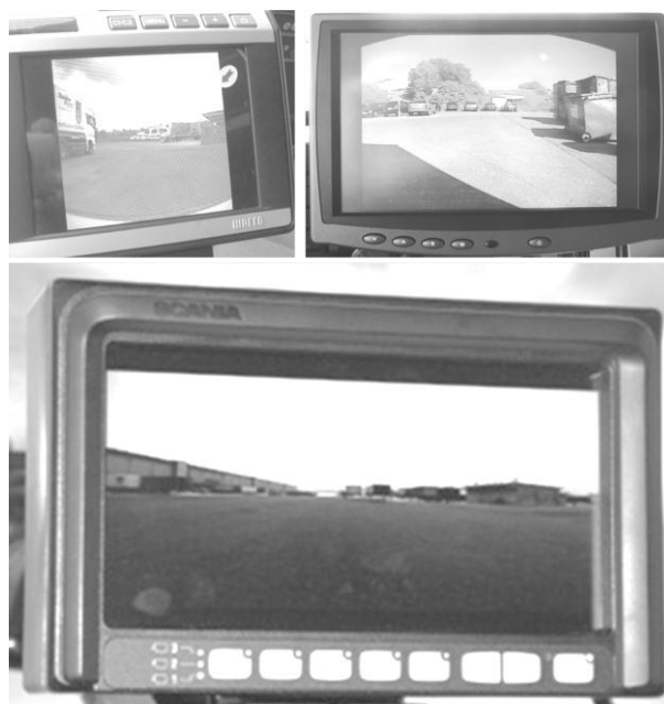
Bild 14 Sichtfelder bei Anbringung der Kamera im Bereich des hinteren Unterfahrschutzes
