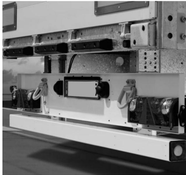
Bild 9 Befestigungslaschen für den RoRo-Verkehr
