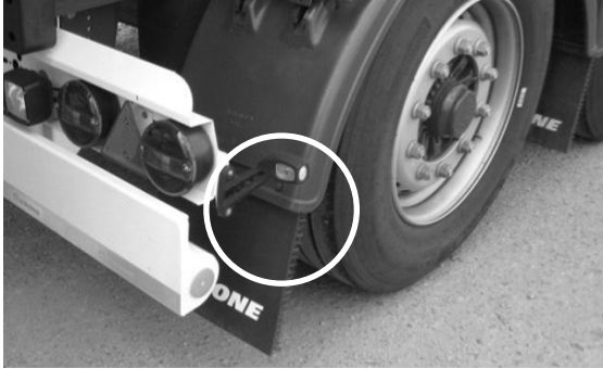
Bild 3 Spurhalteleuchten nach § 51 Absatz 4 der StVZO
