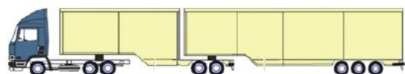
Typ 4: Sattelkraftfahrzeug mit einem weiteren Sattelanhängen bis zu einer Gesamtlänge von 25,25 Metern
