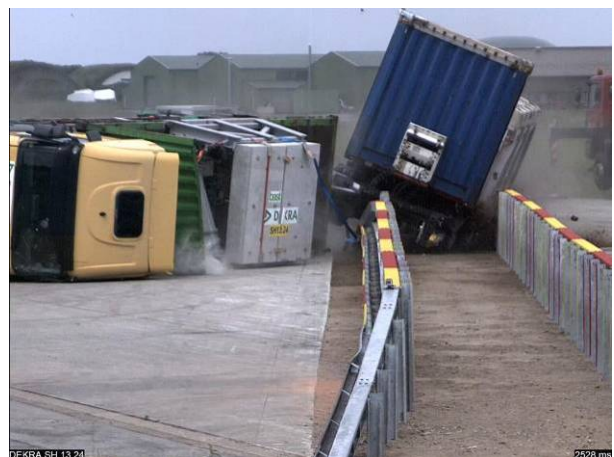
Abbildung 9 Zunehmende Kippneigung des Aufliegers mit Abstützung auf der abgewandten Schutzbarriere
