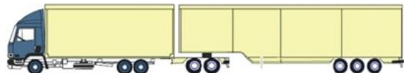
Typ 3: Lastkraftwagen mit Unteretzachse und Sattelanhängen bis zu einer Gesamtlänge von 25,25 Metern
