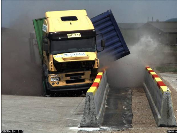
Abbildung 7 Umsturz des Aufliegers auf die Beton-schutzwand, Wegdrücken des Zugfahrzeug-Hecks
