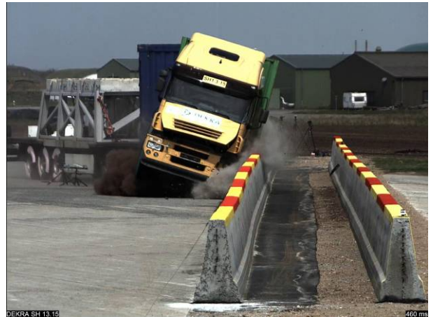
Abbildung 6 Komplettes Anliegen des Zugfahrzeugs an der Schutzeinrichtung und leichtes Kippen ohne Umsturzgefahr
