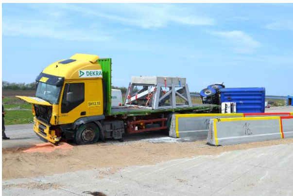
Abbildung 8 Endstellung des Zugfahrzeugs am Ende der Beton-schutzwand
