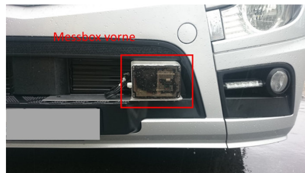
Bild 2 Anbringung der Messboxen am Lang-Lkw
