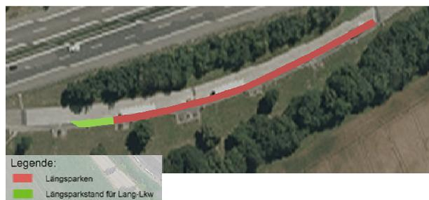
Bild 117: Empfehlung für die Anordnung von Längsparkständen am Beispiel von PWC-Typ 1 (Geoportal Baden-Württemberg)
