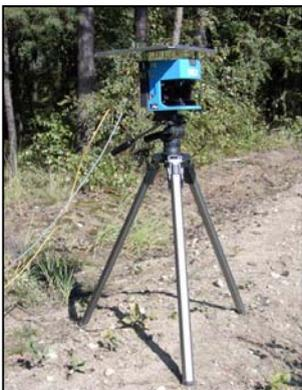
Bild 33: Laserscanner, Typ SICK LMS 200
