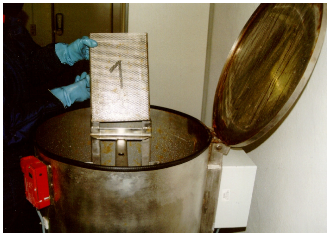
Abbildung 2: Einbringen der Eisplatte (im Drahtkorb) in eine Zentrifuge zum Abschleudern vom geschmolzenen Eis und Tausalz (45 s bei ca. 475 U/min)
