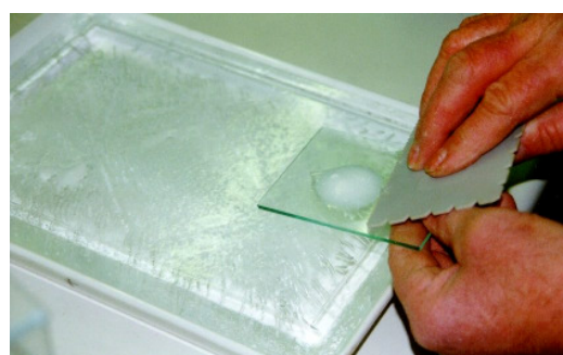
Abbildung 9: Auftragen von Feuchtsalz auf die Eisplatte
