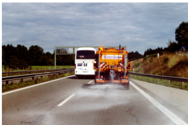
Abbildung 13: Ausbringen von Steinsalz ohne Anfeuchtung (30g/m 2 Streudichte, 6 m Streubreite, 50 km/h Fahrgeschwindigkeit)
