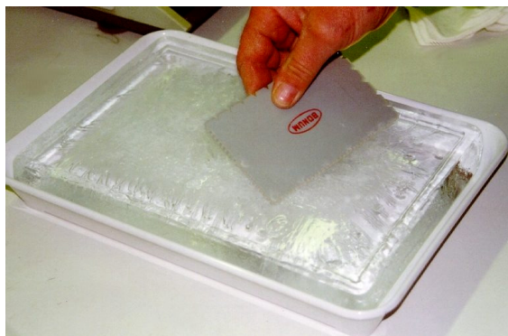
Abbildung 10: Verteilen des Feuchtsalzes auf der Eisplatte mit einem Zahnspatel
