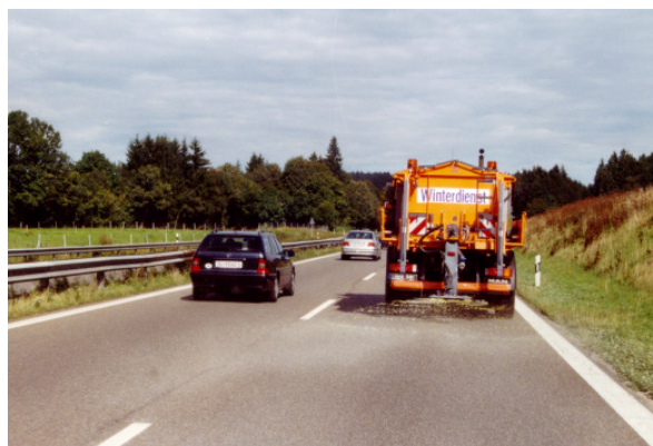
Abbildung 14: Ausbringen von Steinsalz mit Anfeuchtung (FS30-Verfahren, 30 g/m 2 Streudichte, 6 m Streubreite, 50 km/h Fahrgeschwindigkeit)
