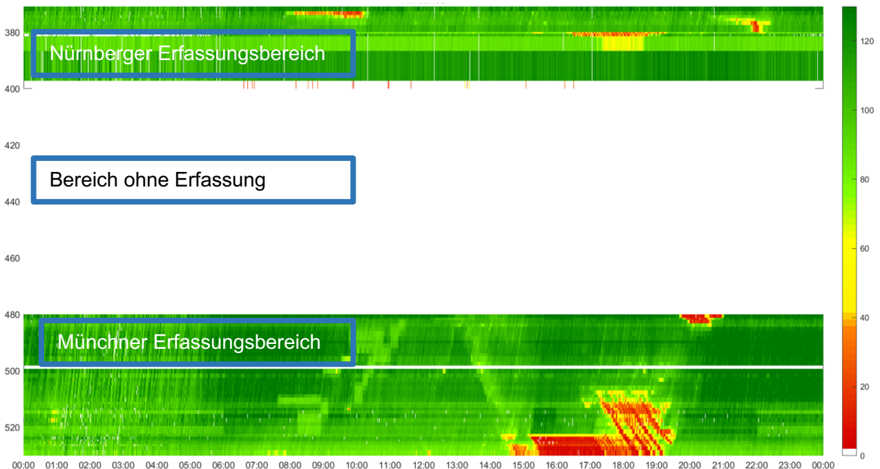
Abbildung 3 Beispiel einer raum-zeitlichen Darstellung aus Überkopf-Rohdaten
