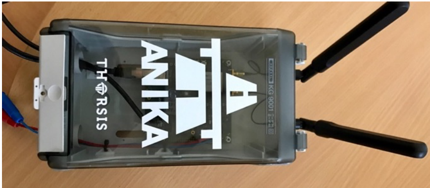
Abbildung 16: Provisorische Lösung der Vehicle-ITS-Station für den initialen Test der elektronischen Komponenten am GATE-IC.
