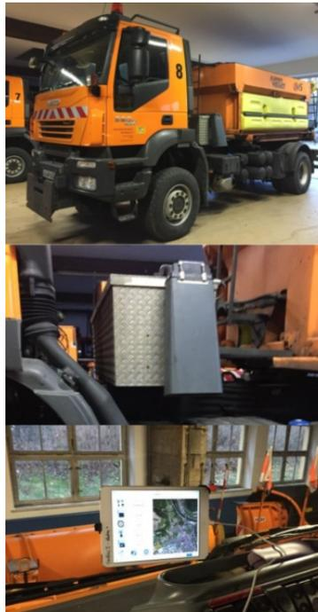
Bilder: Streufahrzeug der AM Greding (oben), montierter Sensor am Streufahrzeug (Mitte) und Monitoring auf einem Tablet im Führerhaus (unten) – Quelle: BASt
