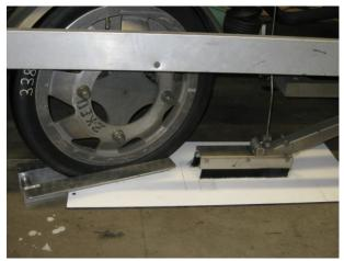
Bild 1: Wasserschuh mit angelegter Schablone
