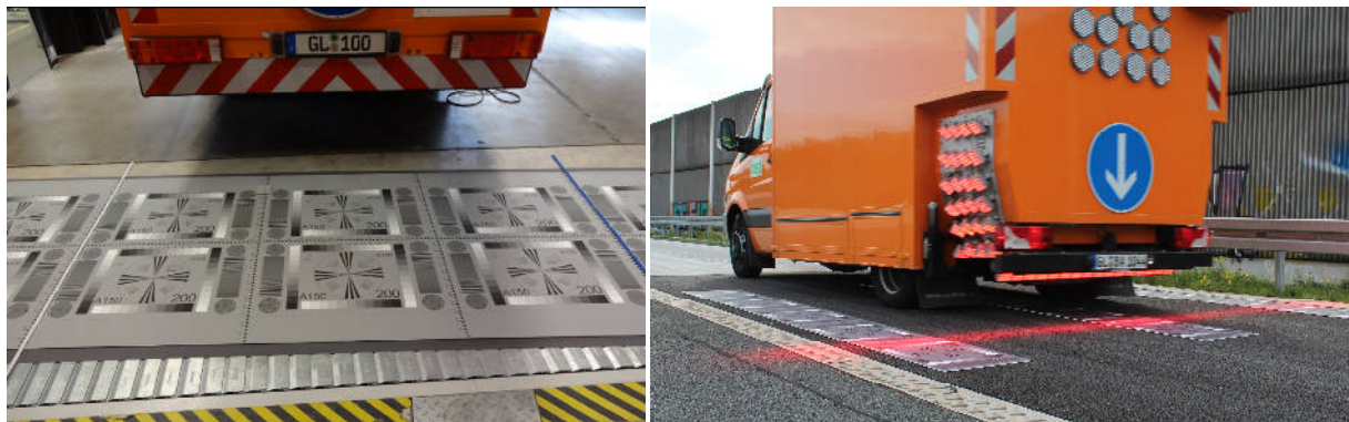
Abbildung 6: Prüfaufbau Bildqualität (Oberflächenbild); links: Flächenkamera, rechts: Zeilenkamera
