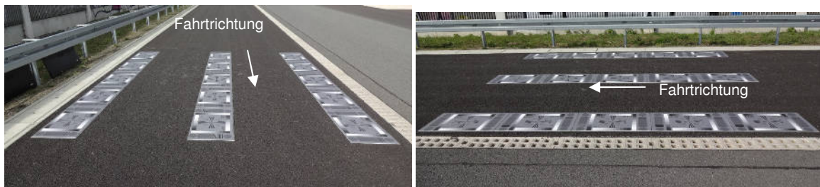
Abbildung 7: Position der Prüftafeln auf dem BASSt-Gelände für die Prüfung der Bildqualität der Flächen- und Zeilenkameras
