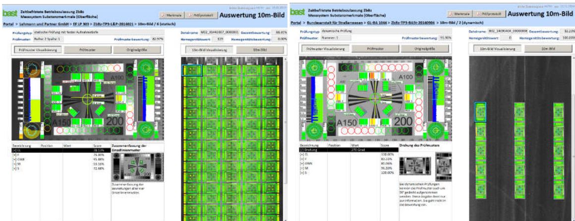
Abbildung 9: Bewertungsergebnis der Bildqualität einer bestandenen statischen Prüfung; links: Flächenkamera, rechts: Zeilenkamera
