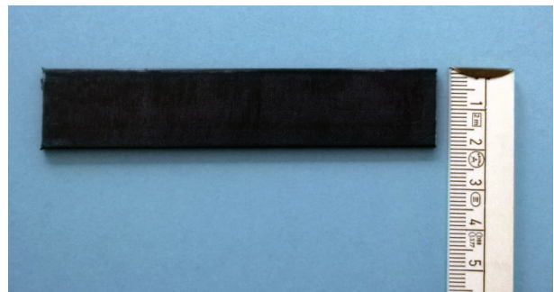
Bild 25: CFK-Lamelle üblicher Höhe zum Einkleben in Schlitze
