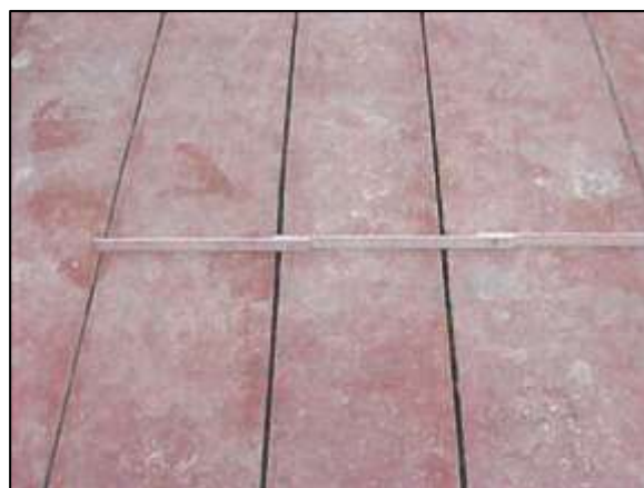
Bild 8: Messen der Schlitztiefe
