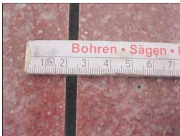
Bild 9: Messen der Schlitzbreite
