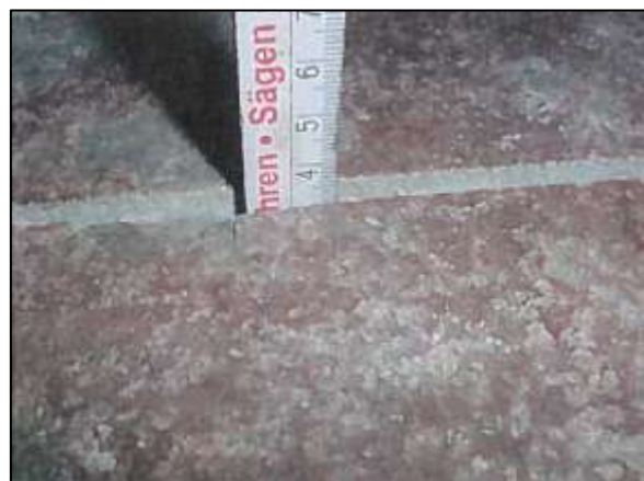
Bild 8: Messen der Schlitztiefe
