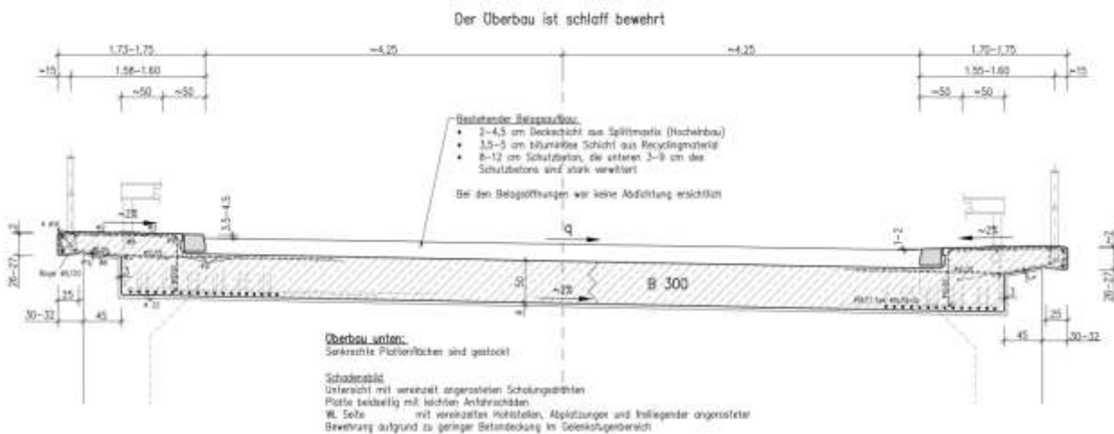
Bild 4: Regelquerschnitt Überbau B-B (Bestand)
