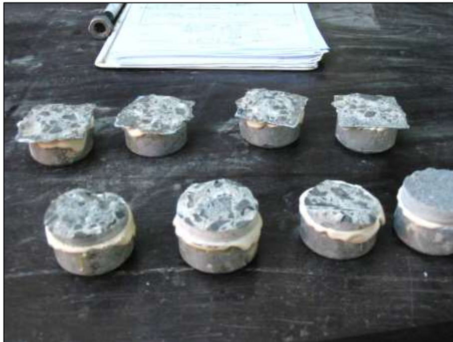
Bild 6: Ermittlung der Haftzugfestigkeit des Bestandsüberbaus
