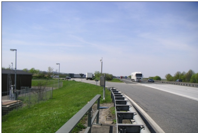
Abb. 5: Messquerschnitt an der BAB 61 in Richtung Koblenz Messstellen PM x , NO x , O 3
