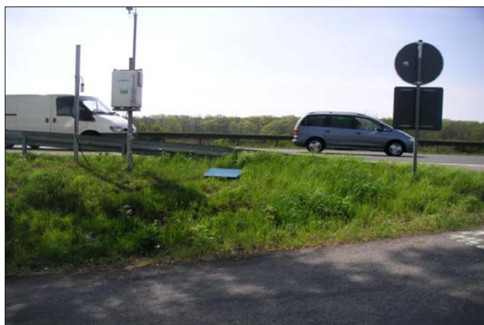
Abb. 9: Messquerschnitt an der BAB 555 in Richtung Wesseling Messstellen PM_x , NO_x , Meteorologie
