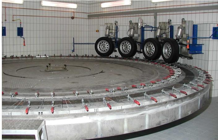
Abbildung 2-1: Rundlaufprüfanlage der BAST
