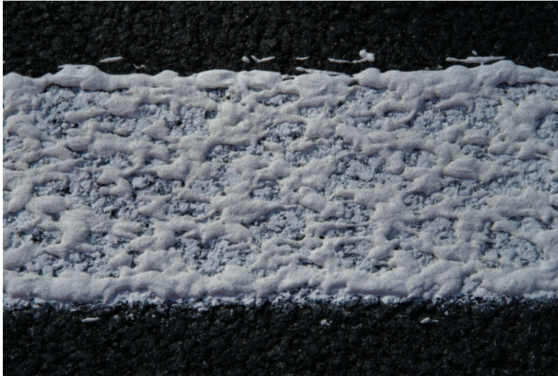
Abbildung 4-1: Agglomeratmarkierung bei Probenahme 01
