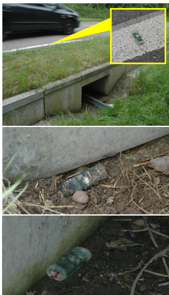
Abbildung 12: Einsatz von Beschleunigungsmessern zur Erfassung von Vibrationen an Schutzanlageanteilen durch den Straßenverkehr
