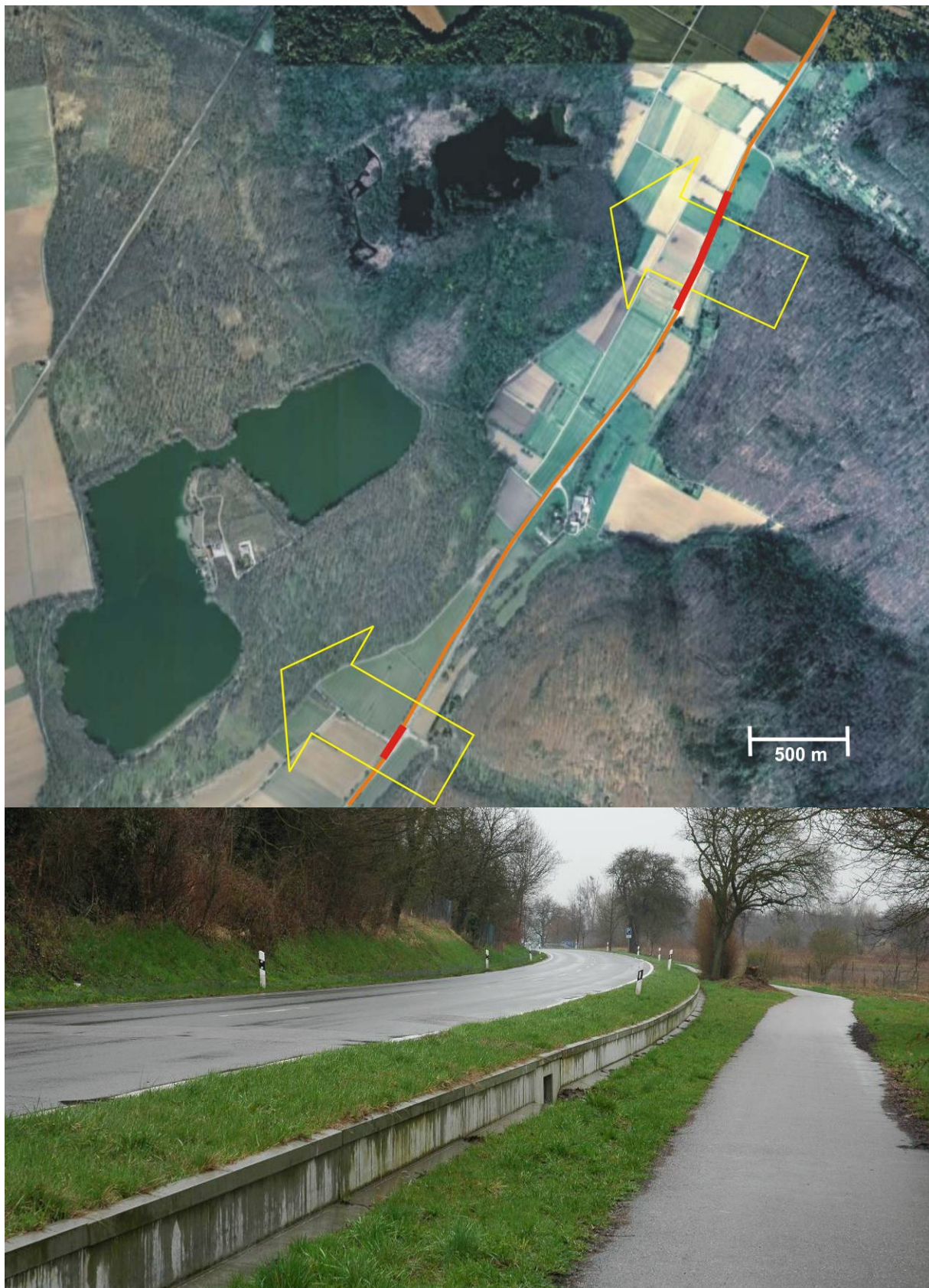
Abbildung 38: Luftbild und Überblicksfoto zur Amphibienschutzanlage (ASA) an der B3 zwischen Karlsruhe-Grötzingen und Weingarten (orange Linie: ASA, rote Linien: Kontrollbereiche, gelber Pfeil: Bereich [früherer] Hauptwanderstrom von Amphibien während der Frühjahrswanderung)
