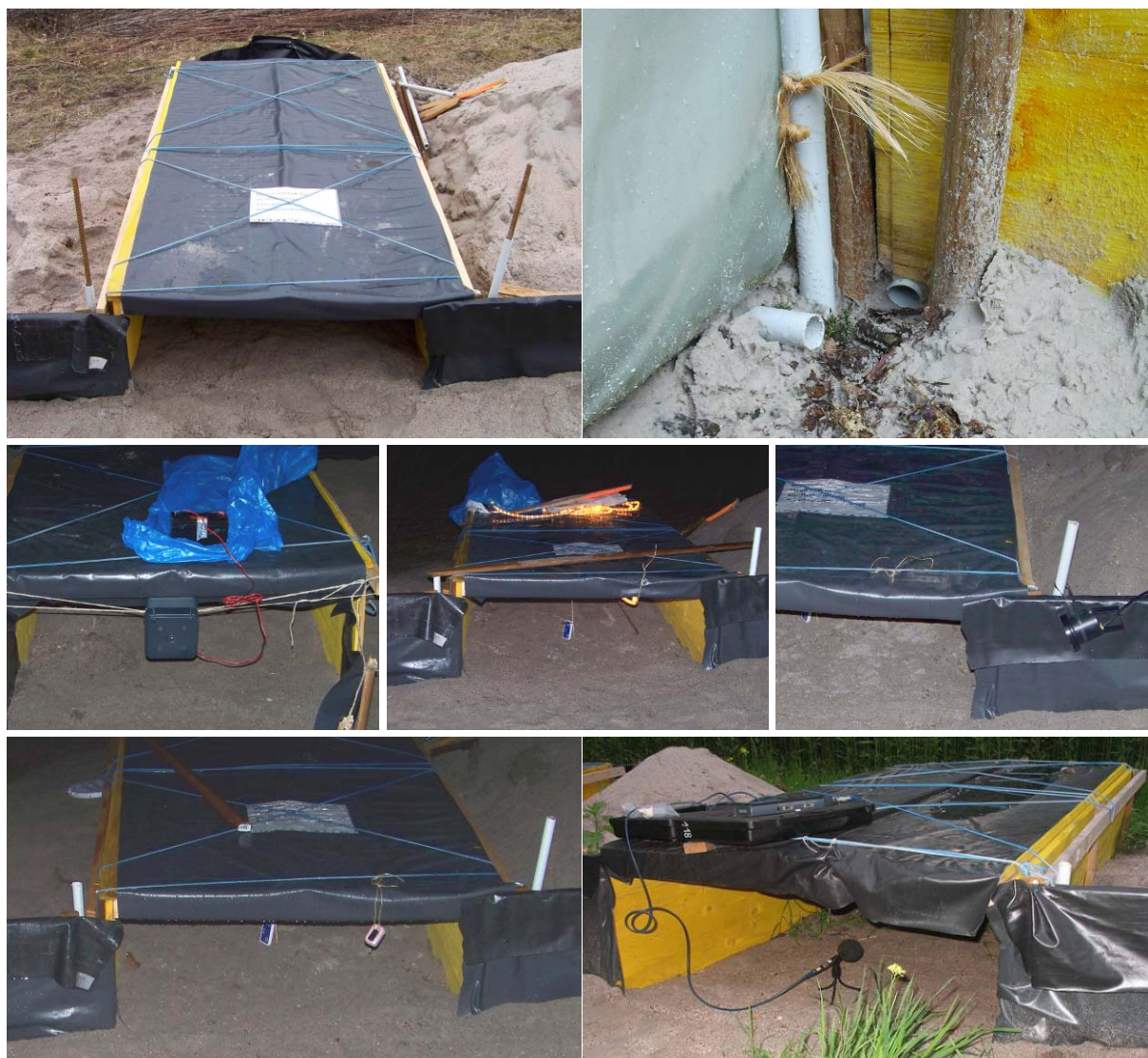
Abbildung 21: Arenaversuchsaufbauten (ferromagnetische Eisenstangen in Plastikrohren um den Tunneleingang herum angeordnet, Tischventilator verursacht Luftzug, Lichtschlauch beleuchtet Tunnelinnere, Lampe mit auf- und abschwellendem Licht am Tunneleingang, MPEG3-Player zur Abspielung von Verkehrsgeräuschen im Tunnel und Messung des erzeugten Schallpegels)
