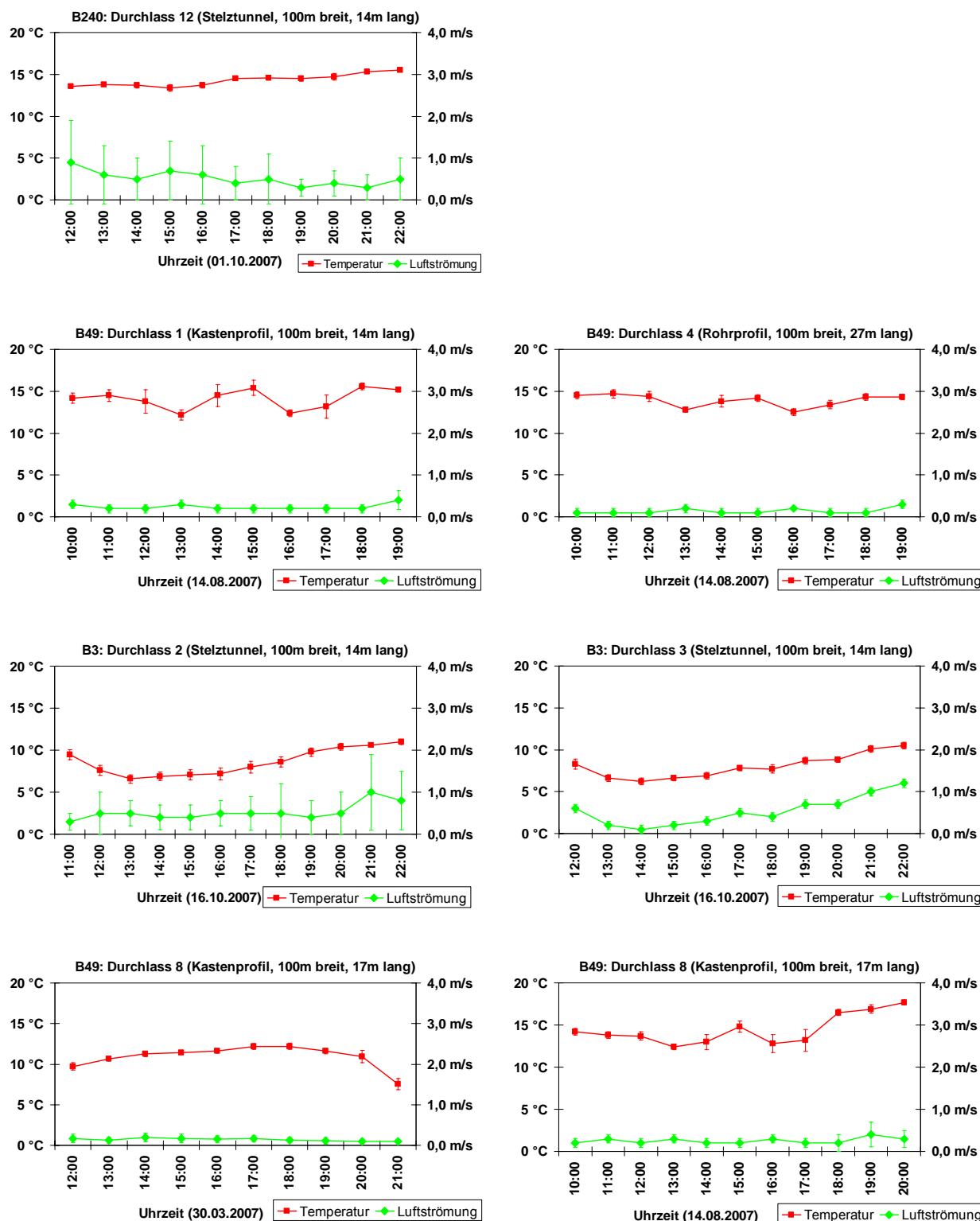
Abbildung 58: Temperaturgänge und Luftzuggeschwindigkeiten im mehrstündigen Verlauf innerhalb verschiedener Durchlässe von Amphibienschutzanlagen
