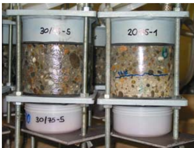
Abbildung 10: Wasserdichte Abdichtung von Bohrprüfkernen im Labor des MPA Wiesbaden
