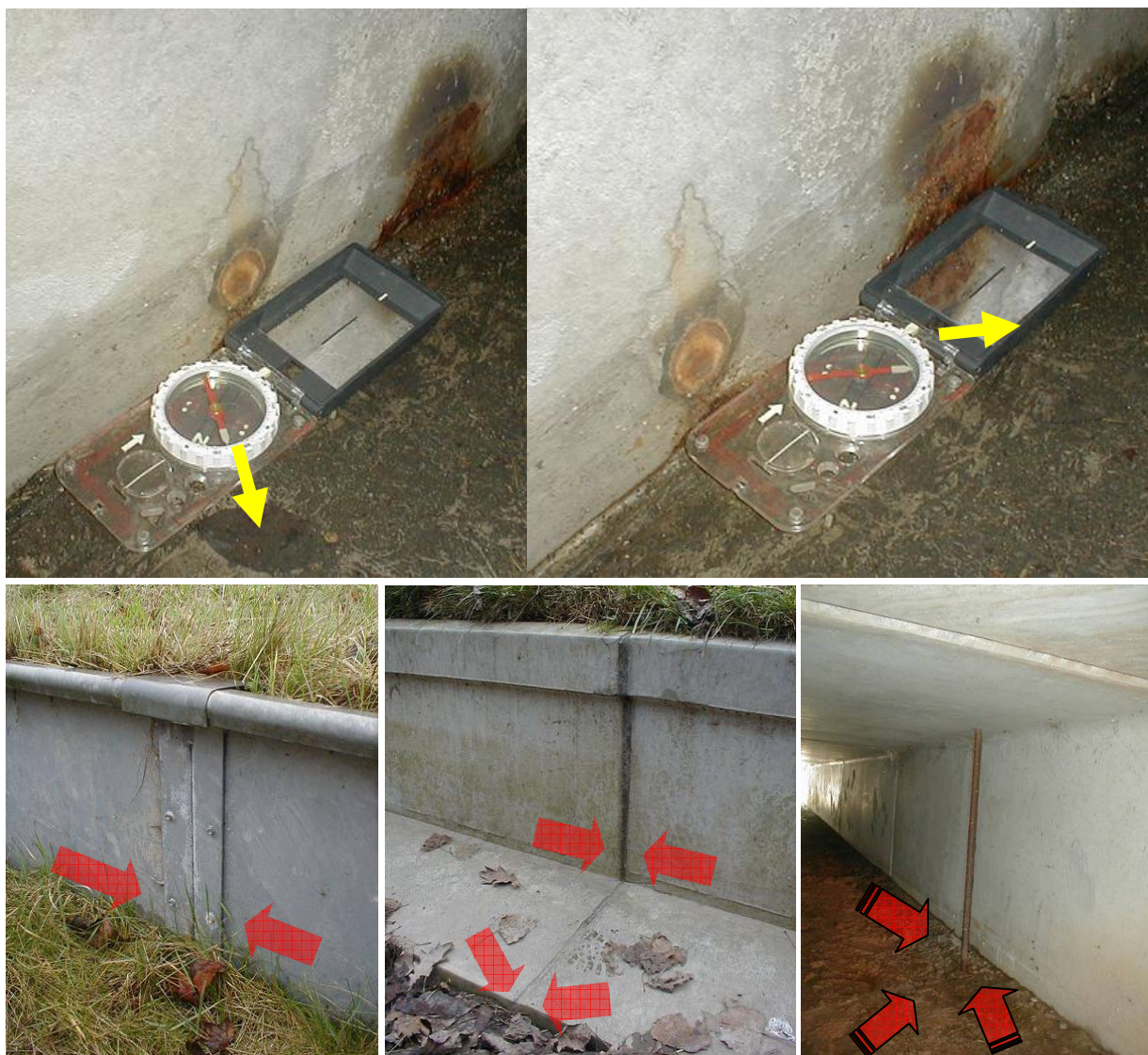
Abbildung 46: Änderung der horizontalen Magnetfelder um 90° auf wenige Zentimeter entlang der Betonwand in der Amphibienschutzanlage an der B 49 bei Koblenz (aus URBANKE 2008) sowie an Fugen und Eisenstangen bis zu 180°
