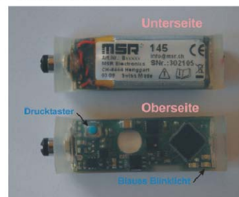
Abbildung 12: Einsatz von Beschleunigungsmessern zur Erfassung von Vibrationen an Schutzanlageanteilen durch den Straßenverkehr
