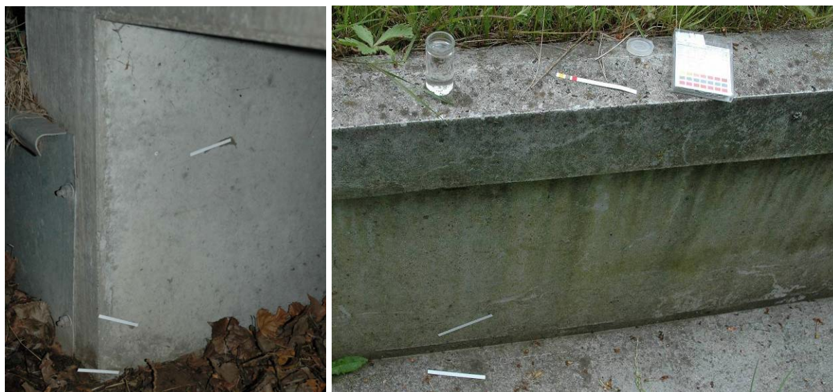
Abbildung 9: Bestimmung des pH-Wertes an verschiedenen Schutzanlageanteilen
