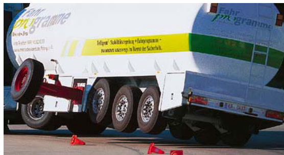
Abbildung 7.1: Kippvorgang eines Sattelaufhängers [Quelle: Mercedes-Benz]
