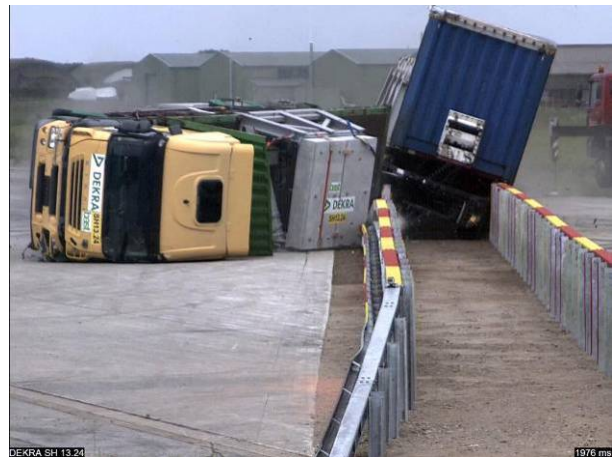
Abbildung 8 Kompletter Umsturz des Zugfahrzeugs auf die Fahrbahn, Aufsitzen des Aufliegers auf dem oberen Kastenprofil der dem Gegenverkehr zugewandten Schutzeinrichtung
