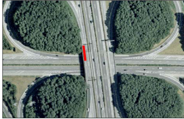
Abbildung 7.2: Beispiel für kurzen Verflechtungsbereich an einem Autobahnknoten
