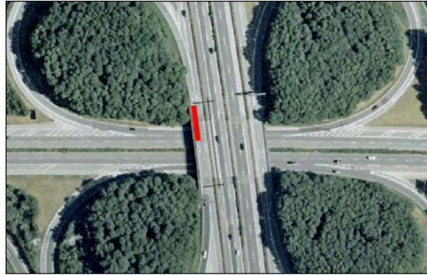
Abbildung 7.2: Beispiel für kurzen Verflechtungsbereich an einem Autobahnknoten
