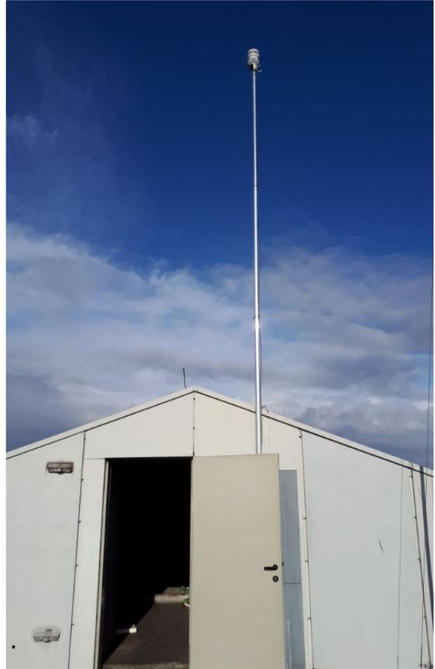
Abbildung 5: Meteorologie-Messtation auf dem Dach der BAST. Messparameter: p, rh, Strg, T, wd und vv.
