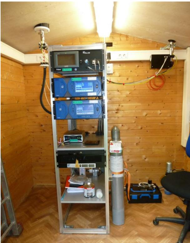
Abbildung 4: Messquerschnitt „A4\_Ol\_2“ der BAB A4 in Fahrtrichtung Olpe – Innenansicht der Messhütte. Messparameter:  $\text{NO}_x$ ,  $\text{PM}_x$ , Partikelanzahl,  $\text{O}_3$ .
