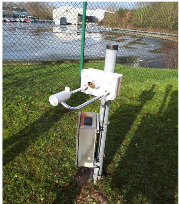
Abbildung 6: Meteorologie-Messtation auf dem rückwärtigen BAST-Parkplatz. Messparameter: p, rh, T, Nsch. Dargestellt ist hier die Nsch-Messung.
