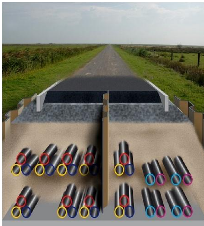
Abbildung 4-2: Leerrohrbauwerk auf Norderney 156
