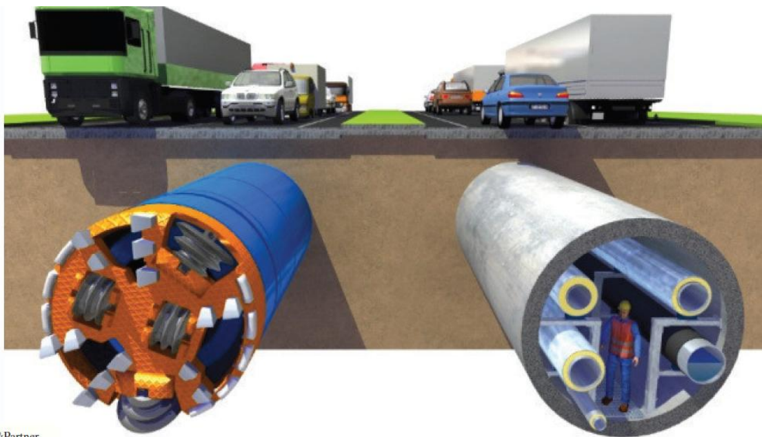
Abbildung 3-18: Power-Tubes, Kabel ohne zusätzlichen Trassenbedarf 126
