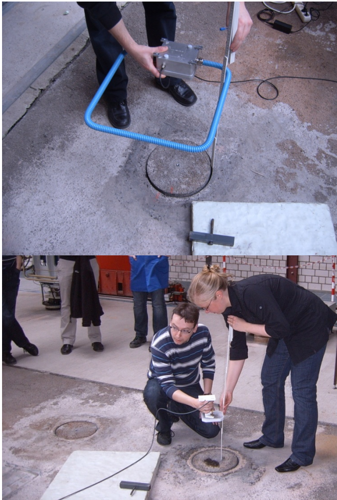
Abbildung 2-16 Während des Auslesens der Transponder wurde die Reichweite der Transponder mit unterschied- lichen Lesegeräten bestimmt. Oben: Reichweitenbestimmung mit dem Mid Range Lesegerät SIR- 2720 für 13,56 MHz und Open Loop Antenne. Unten: Reich- weitenbestimmung mit dem Mid Range Lesegerät SIR-900 für 868 MHz und einer Panel Antenne.
