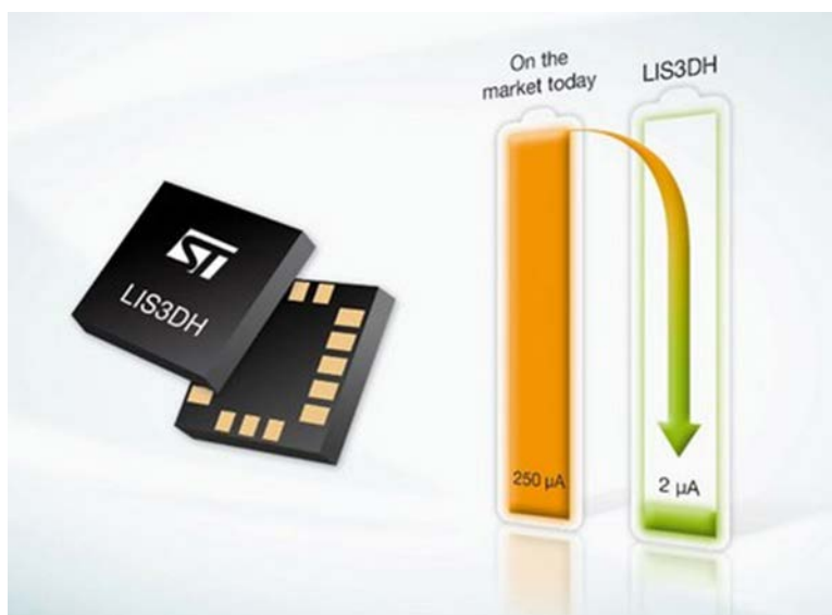
Abbildung 2-8 3-Achsen- Beschleunigungssensor LIS3DH von STMicro- electronics[19]. Die Leistungsauf- nahme konnte im Vergleich zu anderen kommerziellen Beschleunigungs- sensoren von 250 \mu\text{A} auf 2 \mu\text{A} verringert werden.
