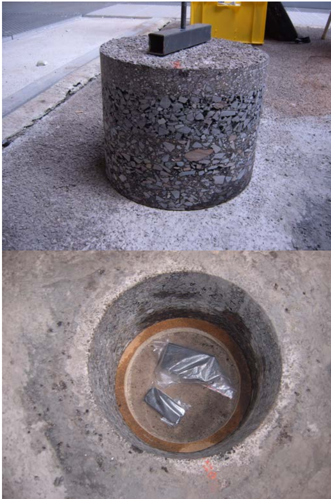
Abbildung 2-15 Oben : Im ausgehobenen Bohrkern sind die einzelnen Schichten der Asphaltstraße zu erkennen Unten: Bohrloch in Asphalt mit eingelassenem UHF- und HF-Transponder. Die Transponder sind aus Schutz vor Wasser in eine Plastiktüte gehüllt.
