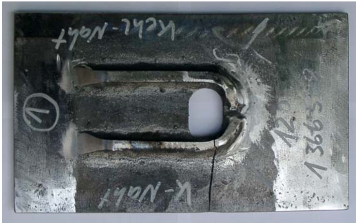
Bild 12: Versuchskörper mit aufgetretenem Riss (Risse traten immer an der Seite mit K- Naht- Schweißung auf)
