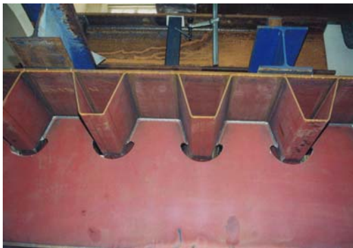
Bild 1: 9,0 m langer QTR- Probekörper der Karlsruher Untersuchungen
