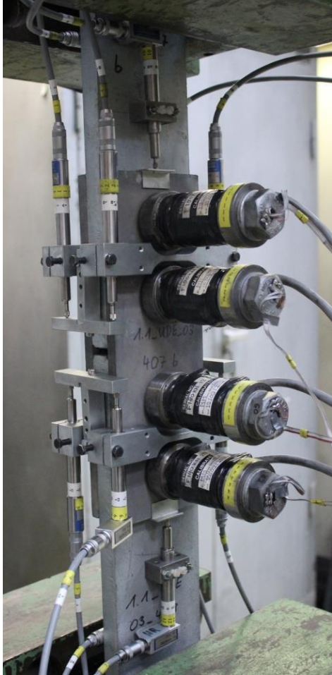
Steife Kraftmessdosen – Eigenbau (LC)
