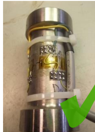
Steife Kraftmessdosen – Eigenbau (LC)
