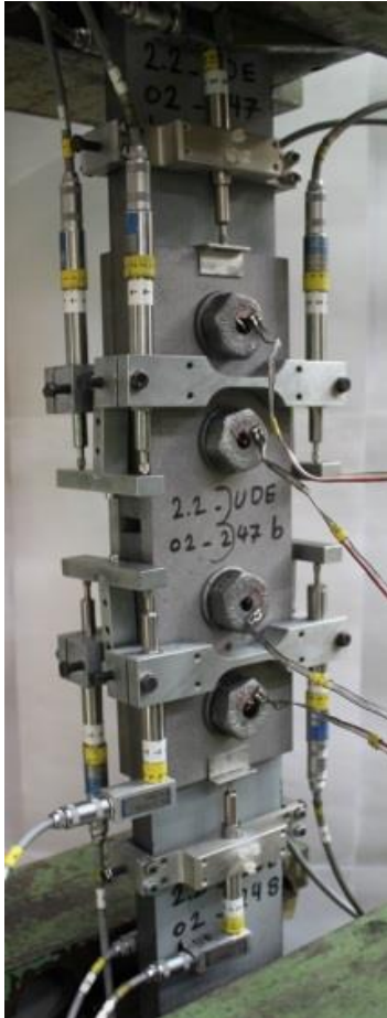
Prüfung einer GV-Verbindung nach DIN EN 1090-2, Anhang G
