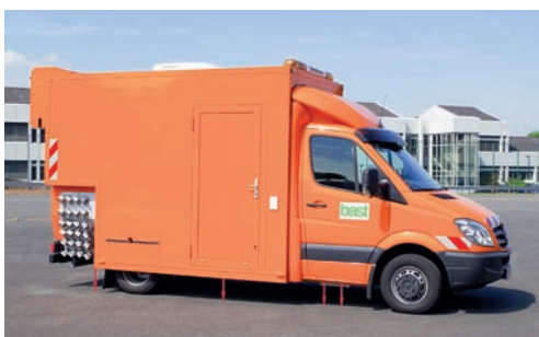
Verfahren zur Erfassung der Längsebenheit: MEFA (Multifunktionales Erfassungssystem zur Fahrbahnoberflächenanalyse (links) und Planograf (rechts)
