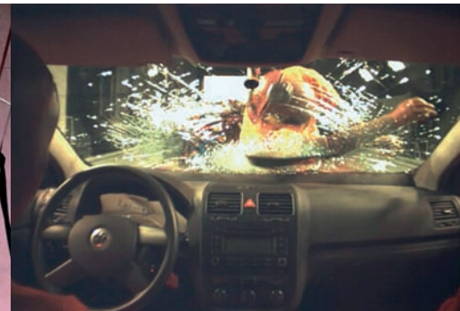
Links: Dummy eines Fahrradfahrers für das Testen von Notbremssystemen Rechts: Kopfaufprall eines Dummies auf Windschutzscheibe
