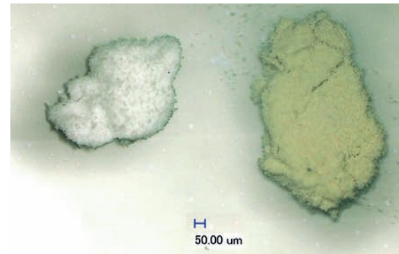
Calciumhydroxid nach Bitumenkontakt und mehrfacher Extraktion (rechts) – zum Vergleich: Calciumcarbonat (links)
