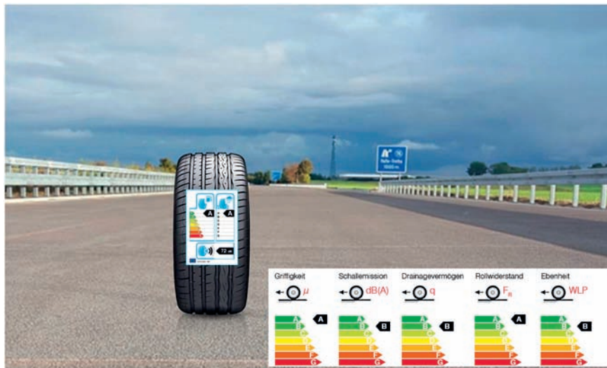
EU-Label Reifen und mögliche Performance Indizes, Fahrbahnoberfläche mit Waschbetontextur
