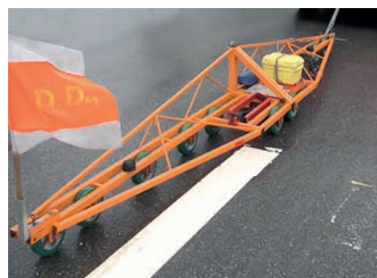
Verfahren zur Erfassung der Längsebenheit: MEFA (Multifunktionales Erfassungssystem zur Fahrbahnoberflächenanalyse (links) und Planograf (rechts)
