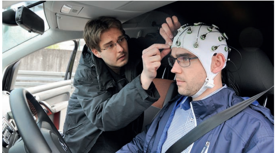
EEG-Ableitung im BAST-Forschungsfahrzeug
