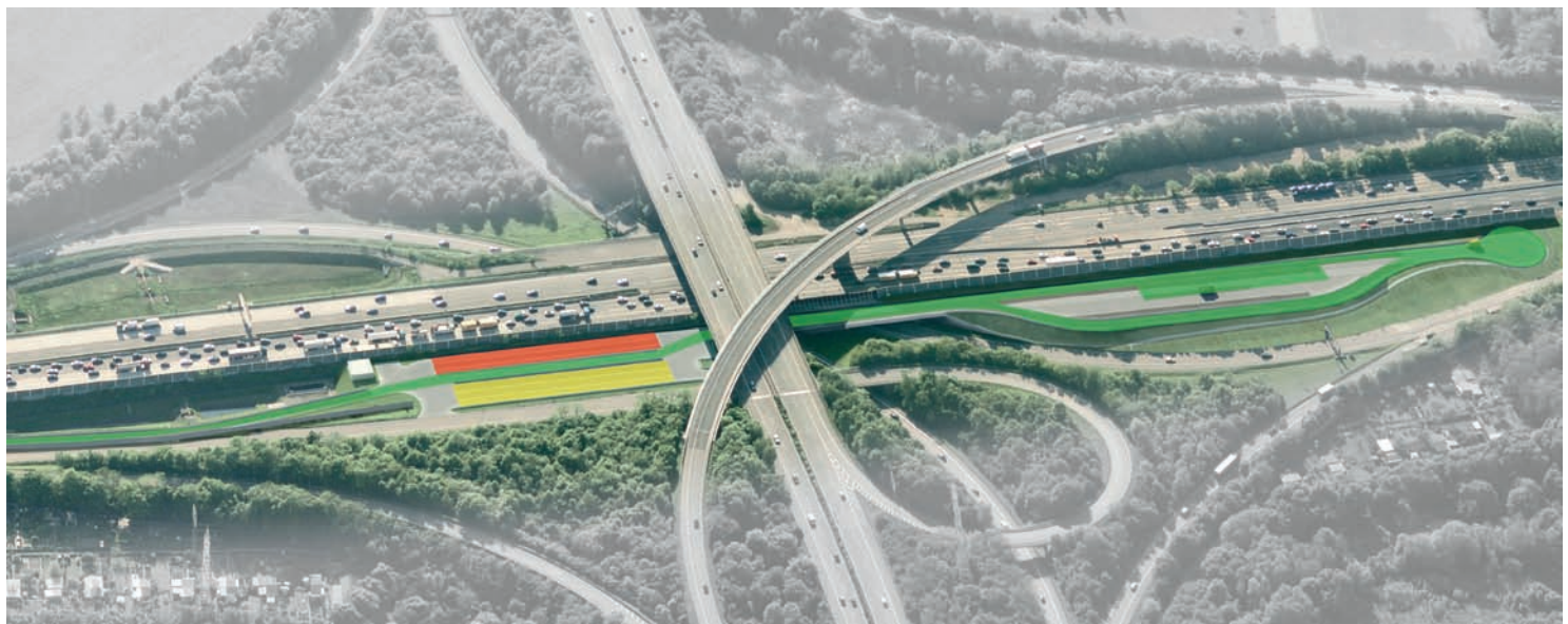
Übersicht über die Referenz- (grün), Untersuchungs- (gelb) und Demonstrationsabschnitte (rot) auf dem duraBAST – die Versuchsstrecke der BAST liegt im Autobahnkreuz Köln-Ost
