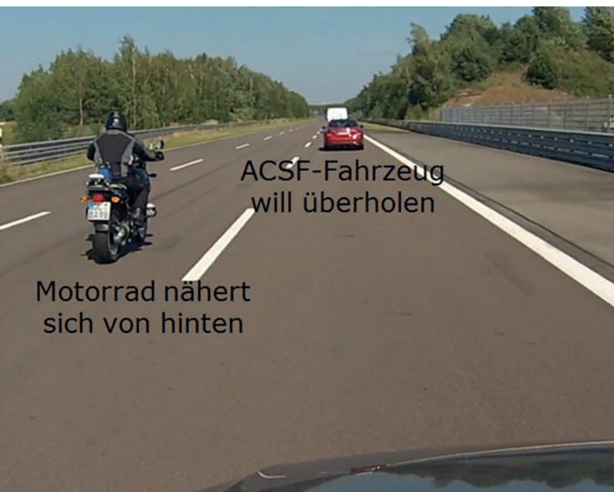
Beispiel für einen Funktionstest für ein ACSF-Fahrzeug bei einem automatisierten Überholmanöver: Der automatisierte Spurwechsel (Überholvorgang) des roten Fahrzeugs muss automatisch abgebrochen werden, wenn sich das Motorrad schon zu weit angenähert hat
