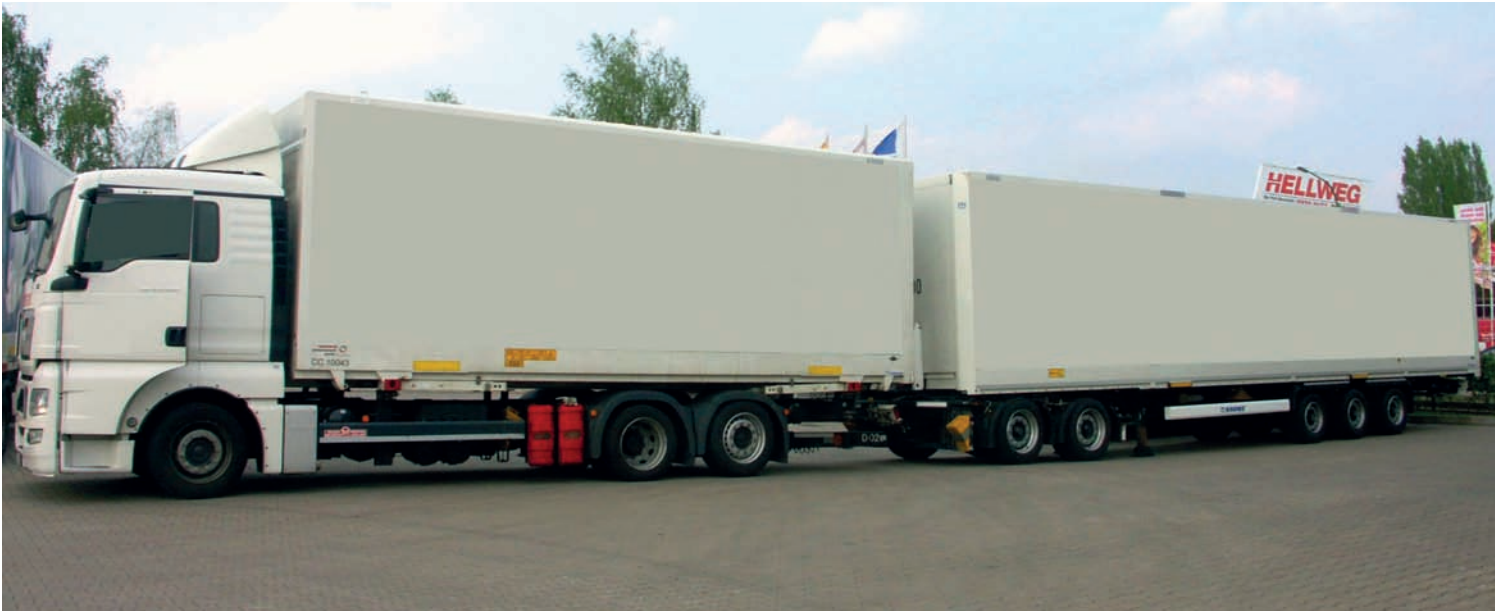
Lang-Lkw vom Typ 3: Motorwagen mit Untersetzachse (Dolly) und Sattelanhänger, Länge=25,25 Meter
