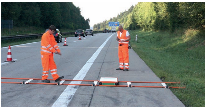
Messtechnische Untersuchung der Dübellage im Rahmen der Streckenuntersuchungen im Autobahnnetz in Südbayern
