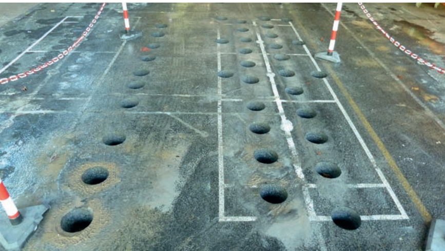
Bohrkerne für Materialuntersuchungen im Rahmen des Innovationsprogramms
