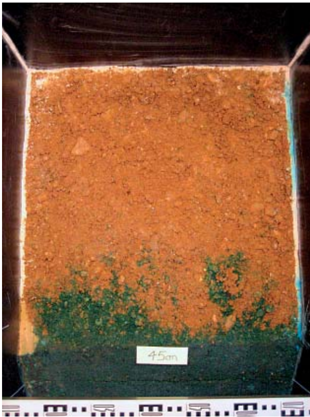
Farbtracerversuch im Hallenlysimeter – Vorbereitung der Untersuchung technischer Sicherungsmaßnahmen
