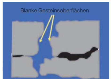
Ablösung des Bitumenfilms
