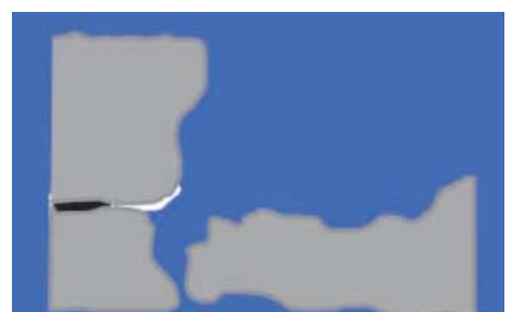
Versagen der Haftung und Kornausbruch
