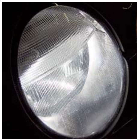
LED-Lichtquelle / Gasentladungsscheinwerfer mit Kunststoffstreuung (150.000 km Laufleistung)
