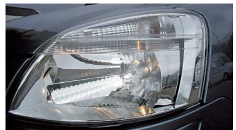
H4-Glühlampe / Scheinwerfer mit H4-Lichtquelle und Kunststoffstreuungsscheibe
