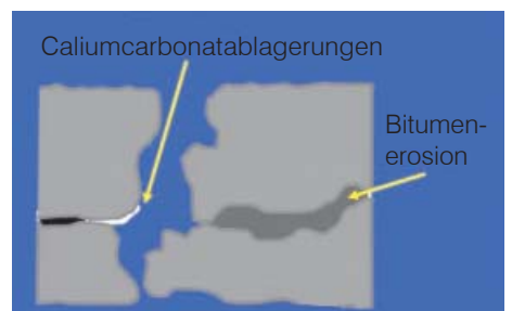
Abbau des Bitumens in den Zwischenbereichen
