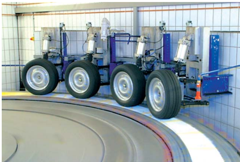
Prüfung der Griffigkeitsentwicklung unter Verkehr in der Rundlaufprüfanlage der BAST
