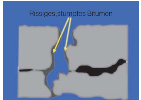
Oxidation und Verhärtung des Bitumenfilms am Gestein
