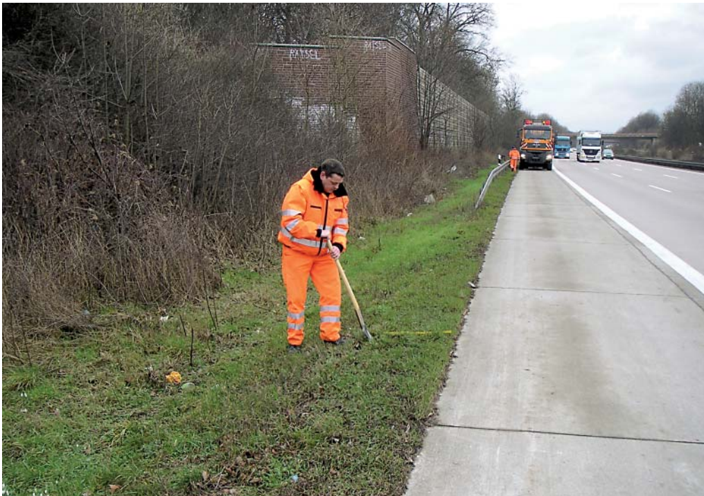
Probenahme von Bankettmaterial an einer Autobahn
