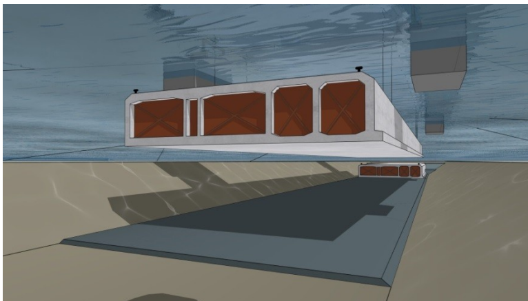
Bild 1: Absenkvorgang eines Elements auf das Fundamentbett
