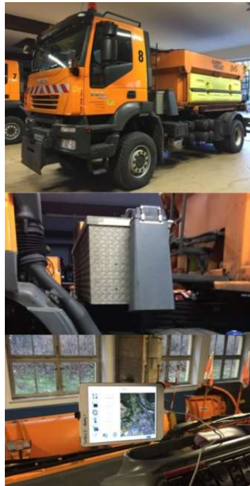
Bilder: Streufahrzeug der AM Greding (oben), montierter Sensor am Streufahrzeug (Mitte) und Monitoring auf einem Tablet im Führerhaus (unten)
