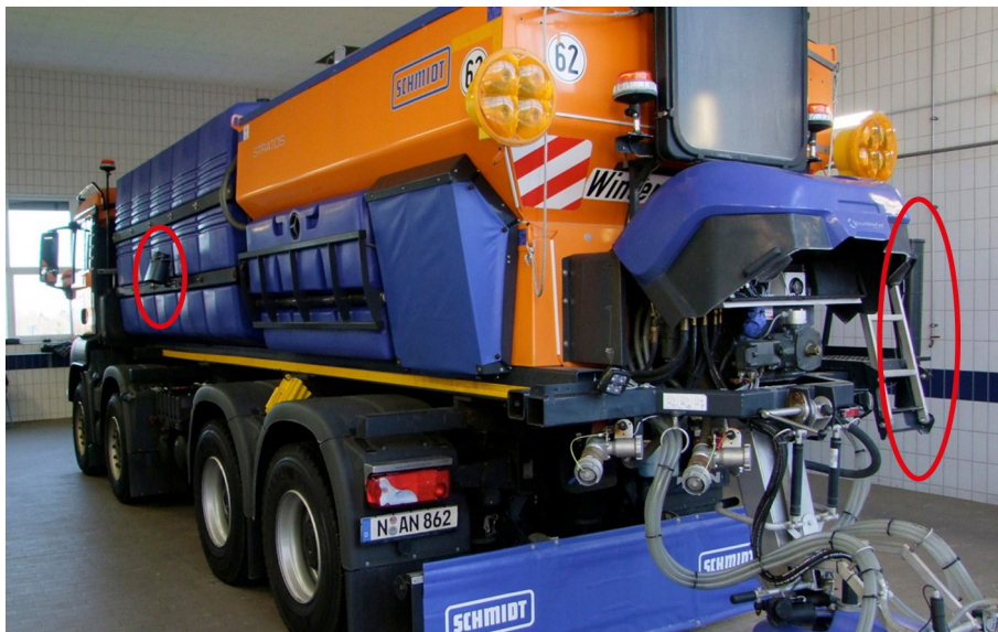
Streufahrzeug mit neuartigen Sensoren für die Fahrbahnzustandserkennung (im Bild rot markiert; Bild: Günter Hausmann)
