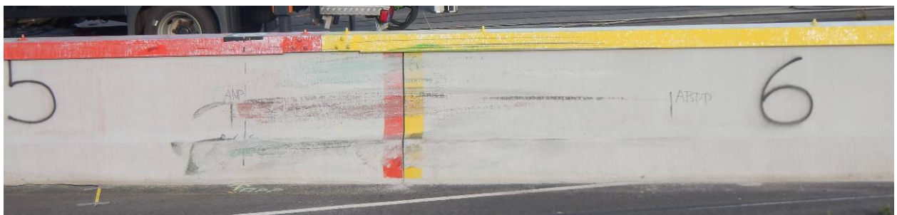
Bild 11 Anprallbereich nach dem Anprallversuch (Ansicht von vorne)
