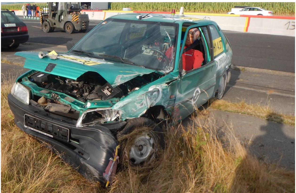
Bild 9 Versuchsfahrzeug nach dem Anprallversuch
