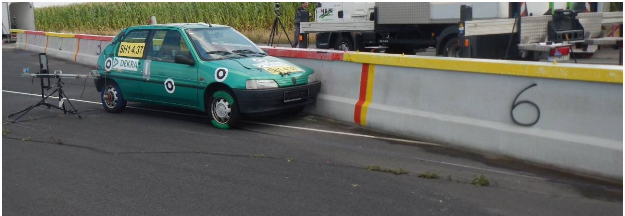
Bild 6 Stellprobe des Fahrzeugs am erwarteten Anprallpunkt
